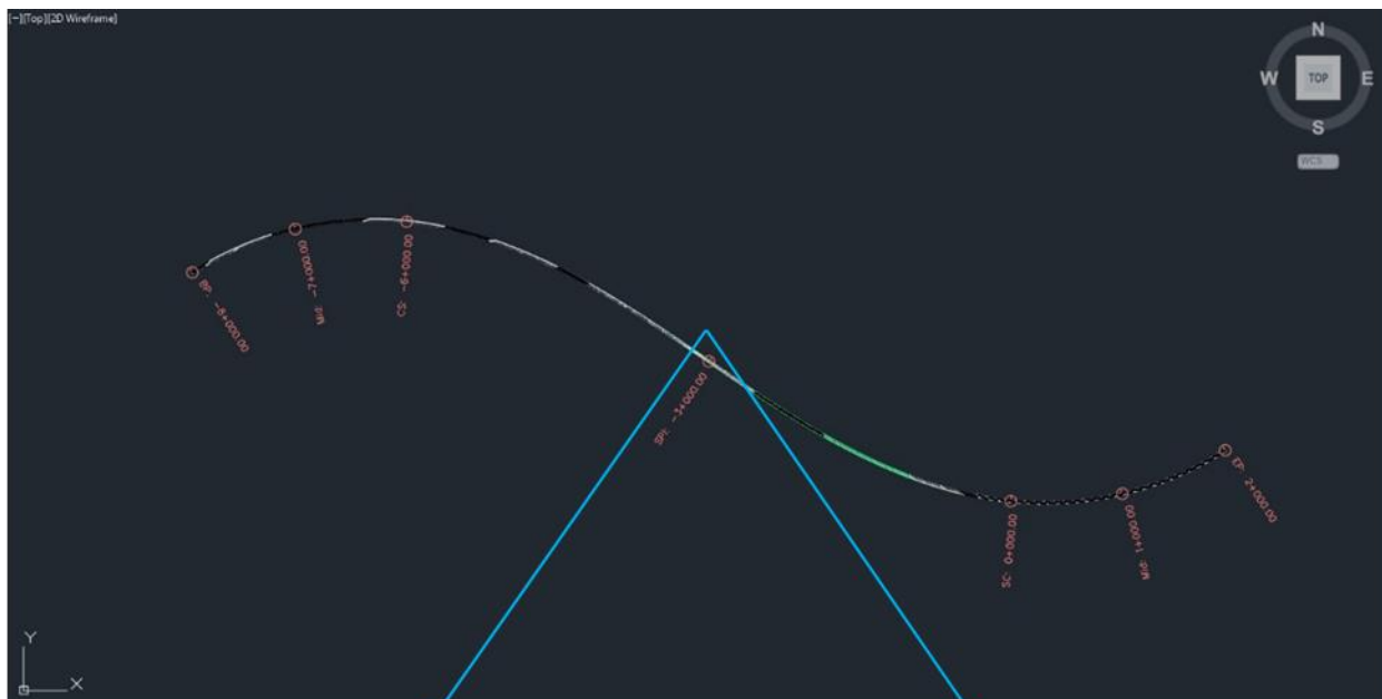
Απόσπασμα (α): Οριζοντιογραφική απεικόνιση του τρισδιάστατου μοντέλου της διάταξης προσαρμογής Κα-Κ-Κ-Κα
