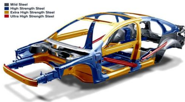
Εικόνα 1: Κατανομή των διαφορετικών χαλύβων στο σασί του αυτοκινήτου, [2]
