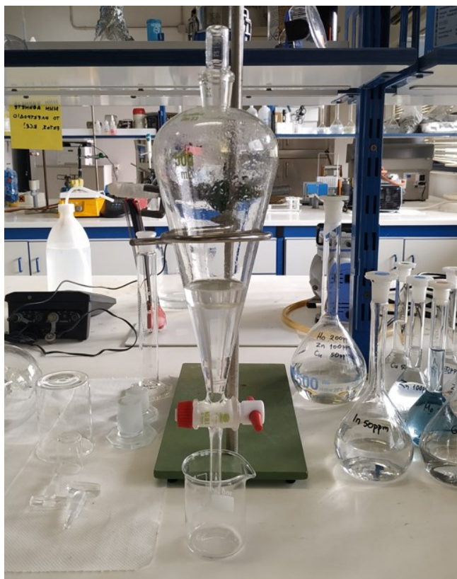
Εικόνα 2.3: Μέρος της πειραματικής διαδικασίας εξαγωγής με οργανικό διαλύτη του εκχυλίσματος TF1 στο Στάδιο 1α. Η διαχωριστική χοάνη περιέχει τον οργανικό διαλύτη D2EHPA (πάνω) και το μεταλλοφόρο εκχύλισμα (κάτω).
