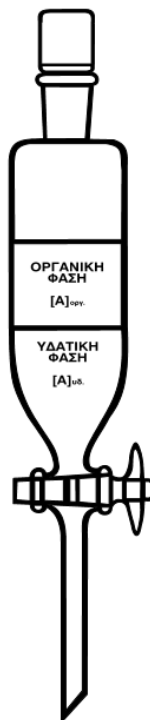
Εικόνα 1.7: Σχηματική αναπαράσταση της διεργασίας «Εξαγωγή με οργανικό διαλύτη» (Αγατζίνη-Λεονάρδου, 2004)
