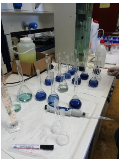
Εικόνα 3.4 Προσδιορισμός TP, χρωματισμός του δείγματος μετά την προσθήκη mix
