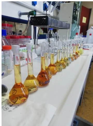
Εικόνα 3.3 Δείγματα για τον προσδιορισμό αμμωνίας μετά την προσθήκη Nessler
