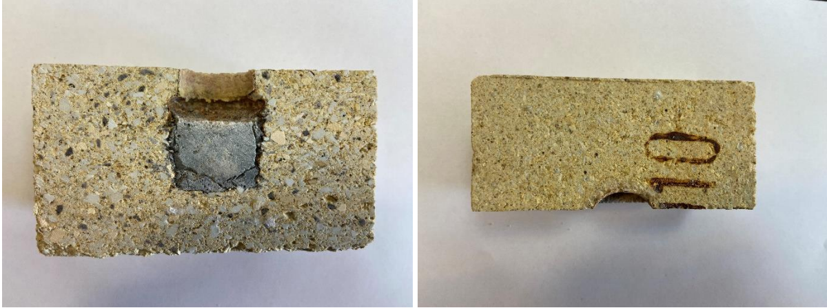
Εικόνα 31. Τομή πυριμάχου – Κρυολίδου Δείγμα 1
