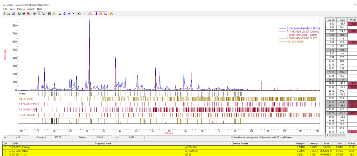
Διάγραμμα 7.5. Ταυτοποίηση φάσεων - ημιποσοτική ορυκτολογική ανάλυση στοιχείων με τη μέθοδο Rietveld για το δείγμα 4 κρυολιθικού υλικού (προσβολή 10 h)
