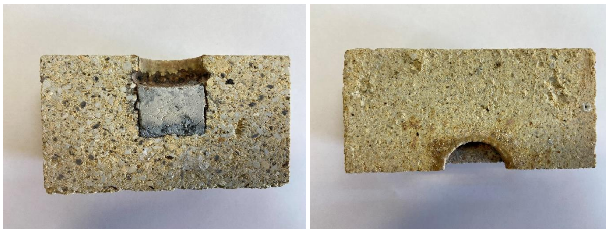
Εικόνα 30. Τομή πυριμάχου – Κρυολίδου Δείγμα 1
