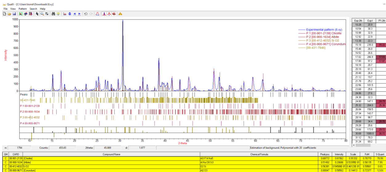
Διάγραμμα 7.4. Ταυτοποίηση φάσεων - ημιποσοτική ορυκτολογική ανάλυση στοιχείων με τη μέθοδο Rietveld για το δείγμα 3 κρυολιθικού υλικού (προσβολή 5 h)
