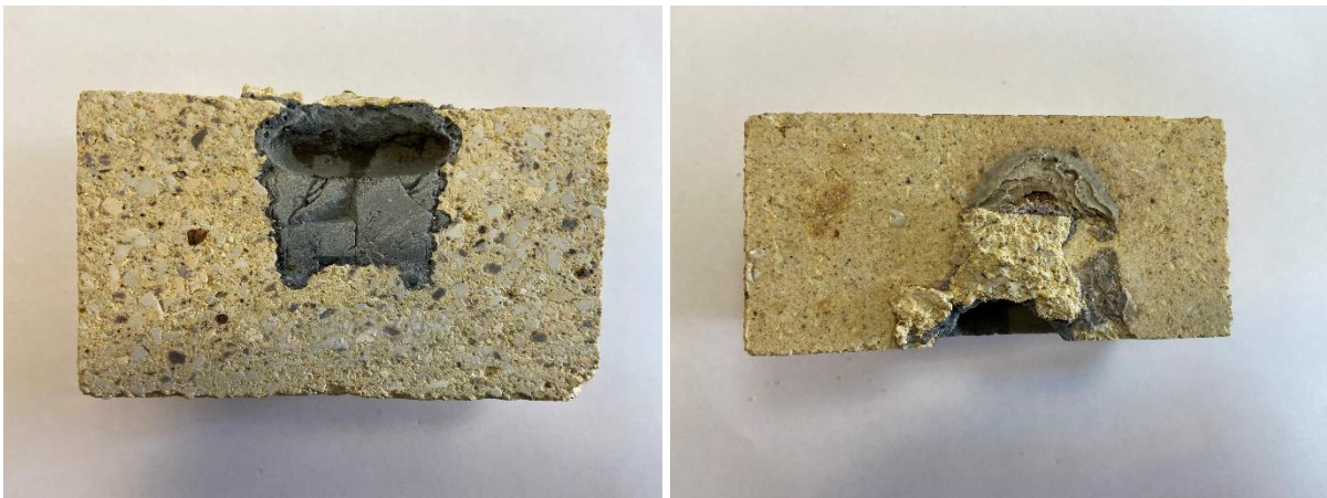
Εικόνα 33. Τομή πυριμάχου – Κρυολίδου Δείγμα 1
