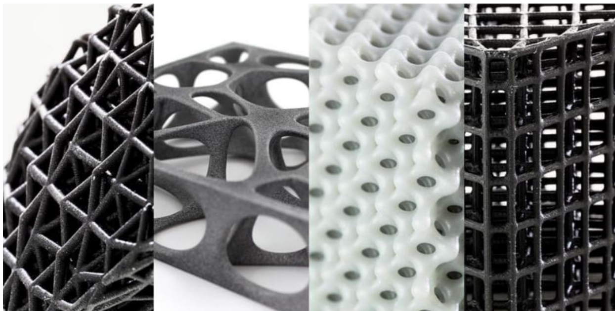
Εικόνα 24: Παραδείγματα α) δομής κελιών πλέγματος, β) μεγέθους και πυκνότητας κελιών, γ) υλικό προσθετικής κατασκευής δ) προσανατολισμός κελιών. Αναφ. [31].
