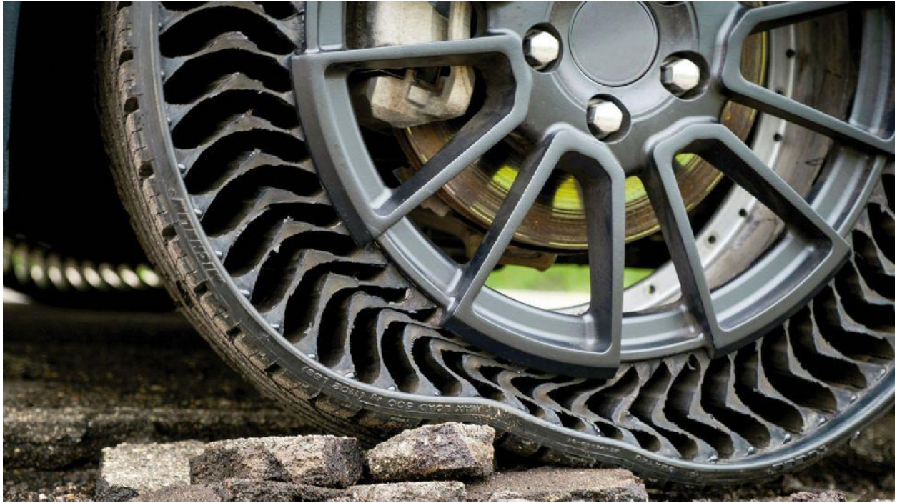
Εικόνα 13: Τα ελαστικά του μέλλοντος είναι φτιαγμένα από 3D εκτυπωτή. Τα συγκεκριμένα μοιάζουν πολύ με την μέθοδο επίπεδου μοτίβου (2,5D) και λόγω έλλειψης αέρα -aerless- δεν αστοχούν εύκολα. Αναφ. [15]
