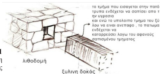
Εικόνα 101 σκαρίφημα ξύλινης δοκού γυναικωνίτη εισερχόμενης στην τοιχοποιία της βόρειας όψης
