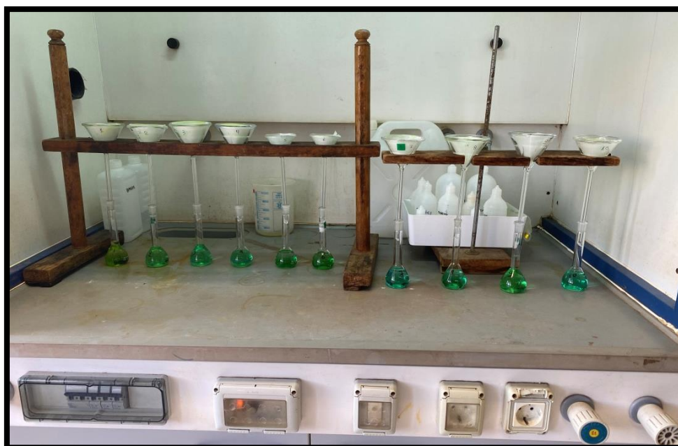
Εικόνα 5.5. Διήθηση μεταλλικών δειγμάτων μετά την διαλυτοποίηση σε ογκομετρικές φιάλες
