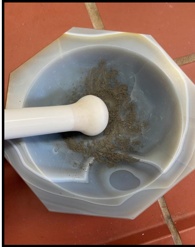
Εικόνα 5.2. Λειοτριβήση δείγματος σκωρίας χαλκού σε γουδί
