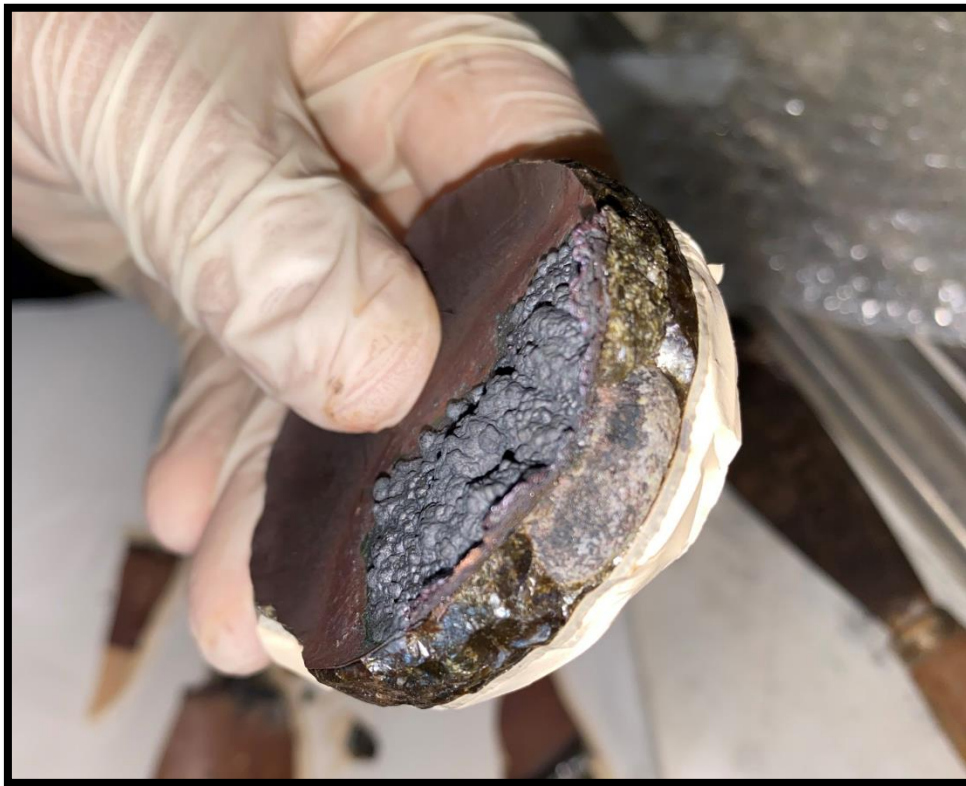
Εικόνα 5.8. Προϊόντα τήξης - Ενσωματωμένο μέταλλο με τη παραγόμενη δευτερογενή σκωρία
