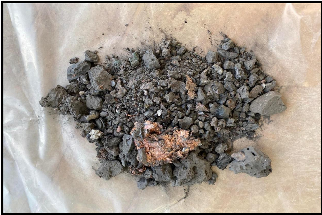
Εικόνα 5.1. Δείγμα σκωρίας χαλκού από την εταιρεία Halcor
