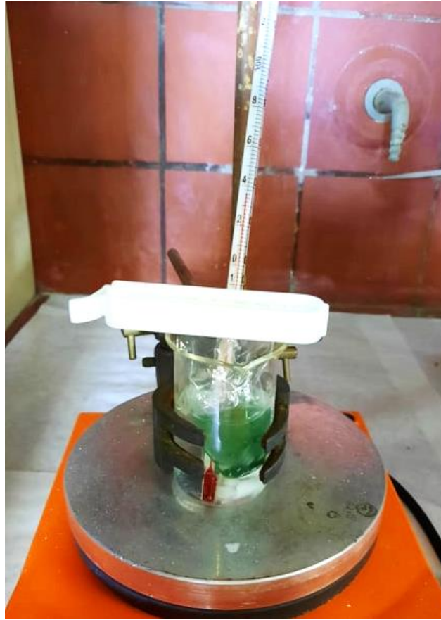
Εικόνα 5.9. Πειραματική διάταξη μεμβράνης διάλυσης διάχυσης για τη μελέτη του προφίλ αποδέσμευσης της κυανίνης IR-786 Iodide.
