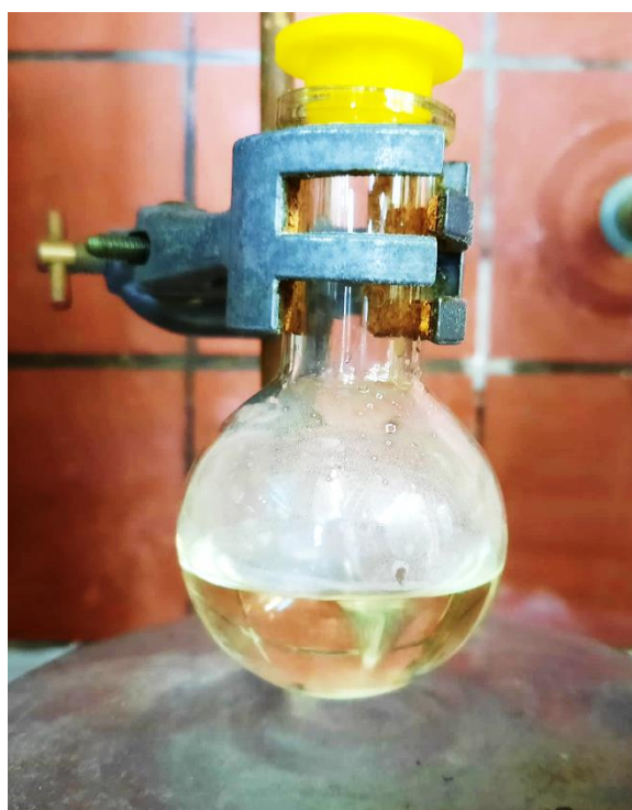
Εικόνα 5.2. Υδατικό διάλυμα χιτοζάνης χαμηλού μοριακού βάρους συγκέντρωσης 0.2% w/v σε διαλύτη γαλακτικό οξύ 1% w/v.
