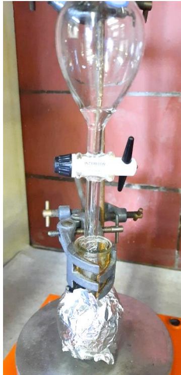
Εικόνα 5.4. Πειραματική διάταξη προσθήκης του cross-linker (υδατικό διάλυμα TPP 0.1 % w/v) υπό έντονη ανάδευση για το σχηματισμό των νανοσωματιδίων μέσω της της τεχνικής ιονικής πηκτωμάτωσης.
