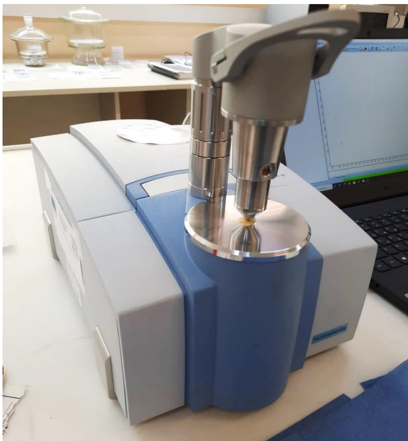
Εικόνα 5.13. Φασματοφωτόμετρο ATR-FTIR της εταιρείας Bruker (μοντέλο Alpha II). Συμπίεση του στερεού δείγματος (CS LMW) με ειδική πρέσα πριν τη μέτρηση για την εξασφάλιση καλής επαφής με τον κρύσταλλο του οργάνου.
