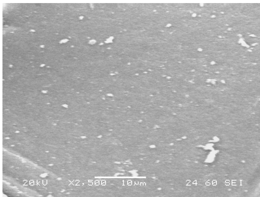
Εικόνα 44: Μικρογραφία SEM του δείγματος TiAg5 (X2500)
