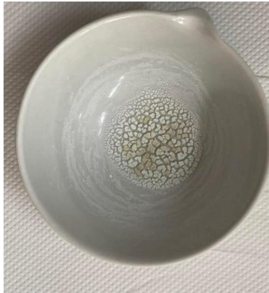
Εικόνα 24: Νανοσωματίδια \text{TiO}_2 μετά από έψηση στους 600^\circ\text{C} για 4 ώρες με ρυθμό 10^\circ\text{C}/\text{min}
