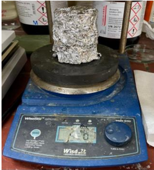
Εικόνα 17: Ανάδευση αιωρήματος \text{TiO}_2/\text{Ag} . Το ποτήρι ζέσεως καλύπτεται με αλουμινόχαρτο
