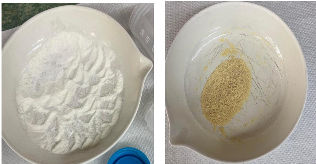
Εικόνα 26: α) Νανοσωματίδια \text{TiO}_2 χωρίς ψήσιμο β) Νανοσωματίδια \text{TiO}_2 μετά από έψηση στους 450^\circ\text{C} για 30 λεπτά με ρυθμό 10^\circ\text{C}/\text{min}
