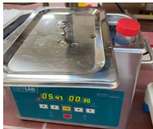
Εικόνα 16: Ανάδευση με υπερήχους U/S αιωρήματος \text{TiO}_2
