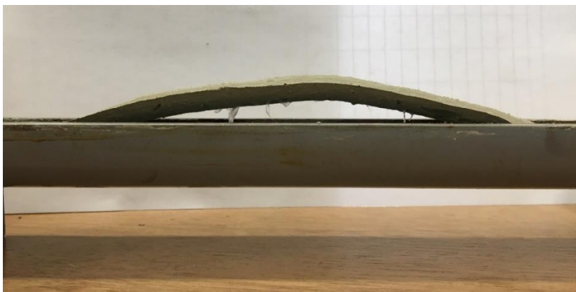
Φωτογραφία 4.2.4.7: Καμπύλωση δοκιμίου Άρμου μετά την ξήρανση στους 110° C
