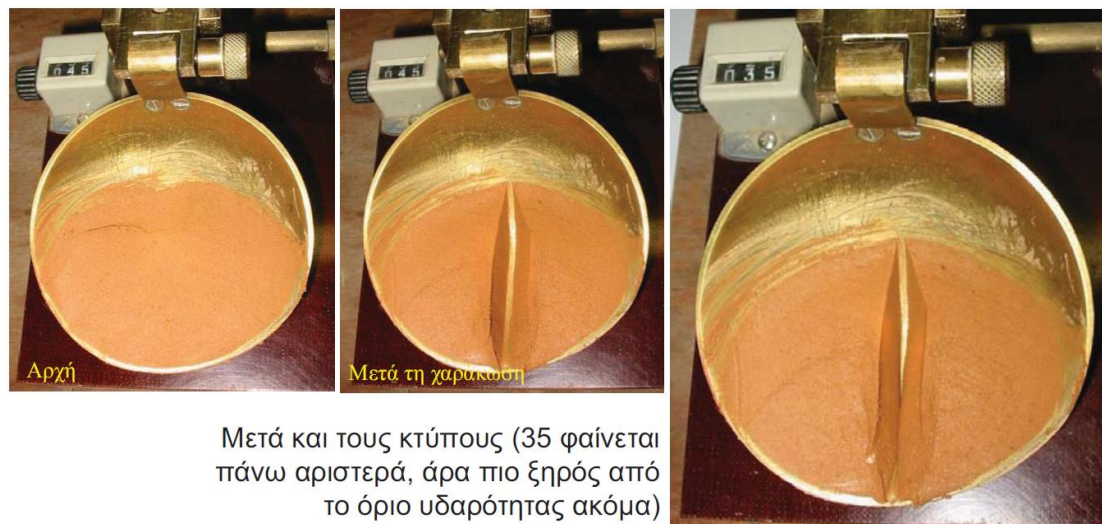
Φωτογραφία 4.2.3.1.2: Αριστερά-Ομοιόμορφη τοποθέτηση του υλικού στην κάψα, Μέση-Διέλευση ειδικού χαρακτήρα από την εδαφική μάζα, Δεξιά-Κλείσιμο χαραγής 12,5mm (Μπαρδάνης, 2019).
