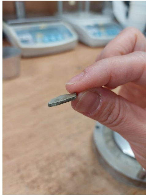
Φωτογραφία 4.3.4.7 & 4.3.4.8: Δείγμα μπεντονιτικής αργίλου Άρμου μετά το πέρας της δοκιμής δακτυλιοειδούς διάτμησης
