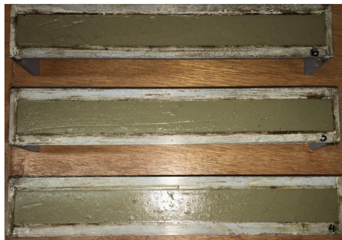
Φωτογραφία 4.2.4.2: Τοποθέτηση του υγρού μίγματος στις φόρμες γραμμικής συρρίκνωσης
