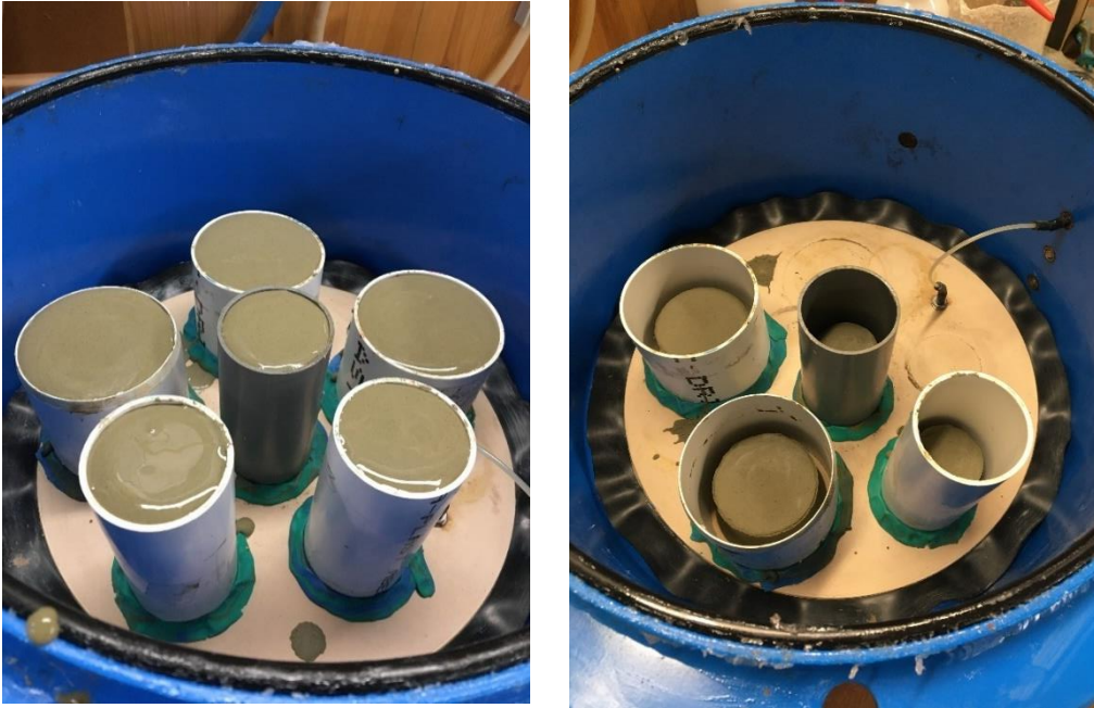
Φωτογραφίες 4.3.1.1.3 & 4.3.1.1.4: Διάταξη δοκιμών μπεντονιτικής αργίλου Άρμου στον θάλαμο μύζησης πριν και μετά την εισροή αέρα υπό πίεση
