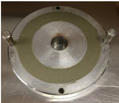
Φωτογραφίες 4.3.4.3 & 4.3.4.4: Αριστερά-Τοποθέτηση του δακτυλιοειδούς δοκιμίου στη συσκευή, Δεξιά- Η κυψέλη με το δοκίμιο μπεντονιτικής αργίλου Άρμου συναρμολογημένη.
