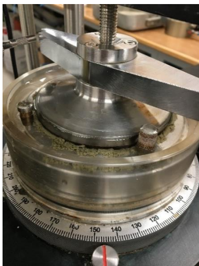
Φωτογραφία 4.3.4.5 & 4.3.4.6: Αριστερά-Πλήρωση της κυψέλης με αποιονισμένο νερό κατά τη διαδικασία της συμπίεσης, Δεξιά-Διαδικασία φόρτισης της μπεντονιτικής αργίλου στα 150 kPa
