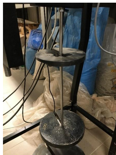
Φωτογραφία 4.3.4.5 & 4.3.4.6: Αριστερά-Πλήρωση της κυψέλης με αποιονισμένο νερό κατά τη διαδικασία της συμπίεσης, Δεξιά-Διαδικασία φόρτισης της μπεντονιτικής αργίλου στα 150 kPa
