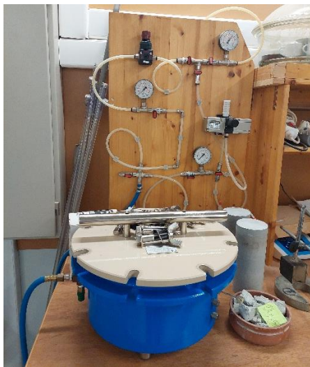
Φωτογραφίες 4.3.1.1.1 & 4.3.1.1.2: Αριστερά-Θάλαμος μύζησης εργαστηρίου ΕΔΑΦΟΣ, Δεξιά-Σχέδιο λειτουργίας θαλάμου μύζησης, Αρχή της μεθόδου μετατόπισης άξονα για τη μέτρηση της μύζησης (Μπαρδάνης, 2016)
