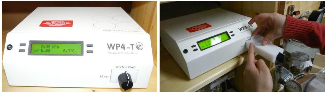
Φωτογραφίες 4.3.1.2.2 & 4.3.1.2.3: Το υγρόμετρο ψυχρού κατόπτρου του εργαστηρίου της ΕΔΑΦΟΣ Α.Ε. κατασκευής Decagon Devices, Inc. -ννν METER Environmental (Μπαρδάνης, 2016)
