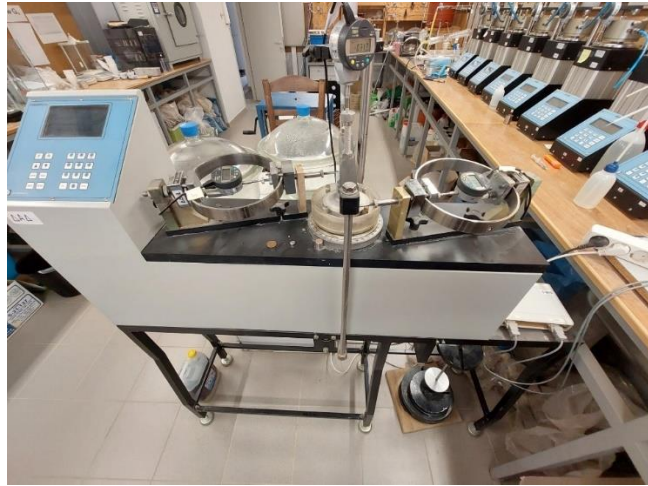
Φωτογραφία 4.3.4.1: Συσκευή δακτυλιοειδούς διάτμησης εργαστηρίου ΕΔΑΦΟΣ Α.Ε.
