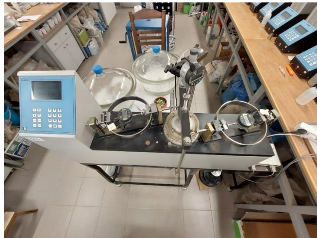
Φωτογραφία 4.3.4.2: Συσκευή δακτυλιοειδούς διάτμησης εργαστηρίου ΕΔΑΦΟΣ Α.Ε.
