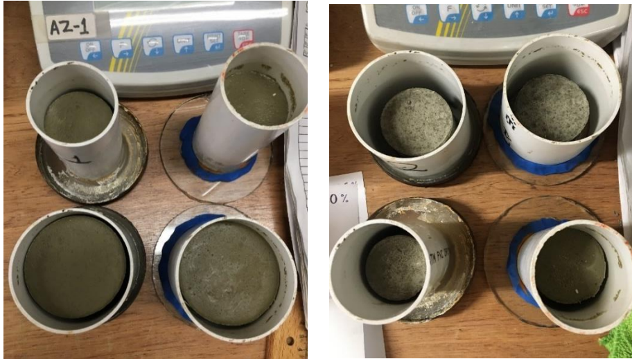
Φωτογραφίες 4.3.1.3.1-4: Σταδιακή μείωση του ποσοστού υγρασίας της μπεντονιτικής αργίλου Άρμου κατά την ξήρανση των δειγμάτων στην ατμόσφαιρα.
