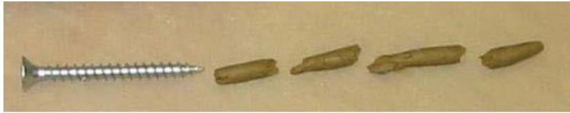
Φωτογραφία 4.2.3.2.1: Μορφοποιημένο, ελαφρώς ρωγματωμένο υλικό διαμέτρου 3mm (Μπαρδάνης, 2019).
