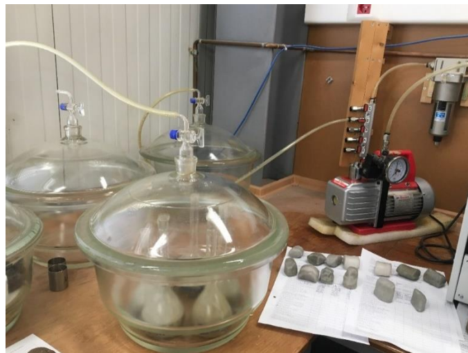
Φωτογραφία 4.2.5.1: Θάλαμος απαέρωσης συνδεδεμένη με αντλία κενού για τον υπολογισμό του G_s
