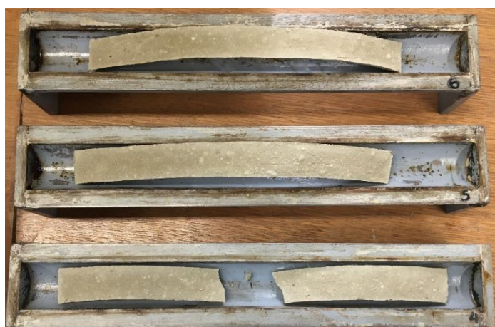
Φωτογραφία 4.2.4.5: Μπεντονιτική άργιλος Άρμου με 24 ώρες ξήρανσης σε φούρνο θερμοκρασίας 110° C
