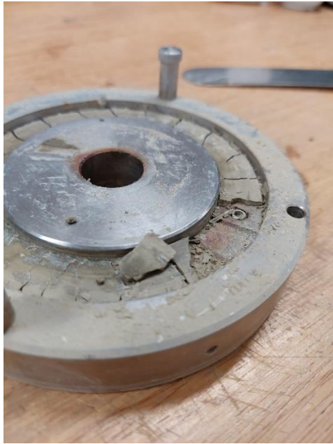
Φωτογραφία 4.3.4.7 & 4.3.4.8: Δείγμα μπεντονιτικής αργίλου Άρμου μετά το πέρας της δοκιμής δακτυλιοειδούς διάτμησης
