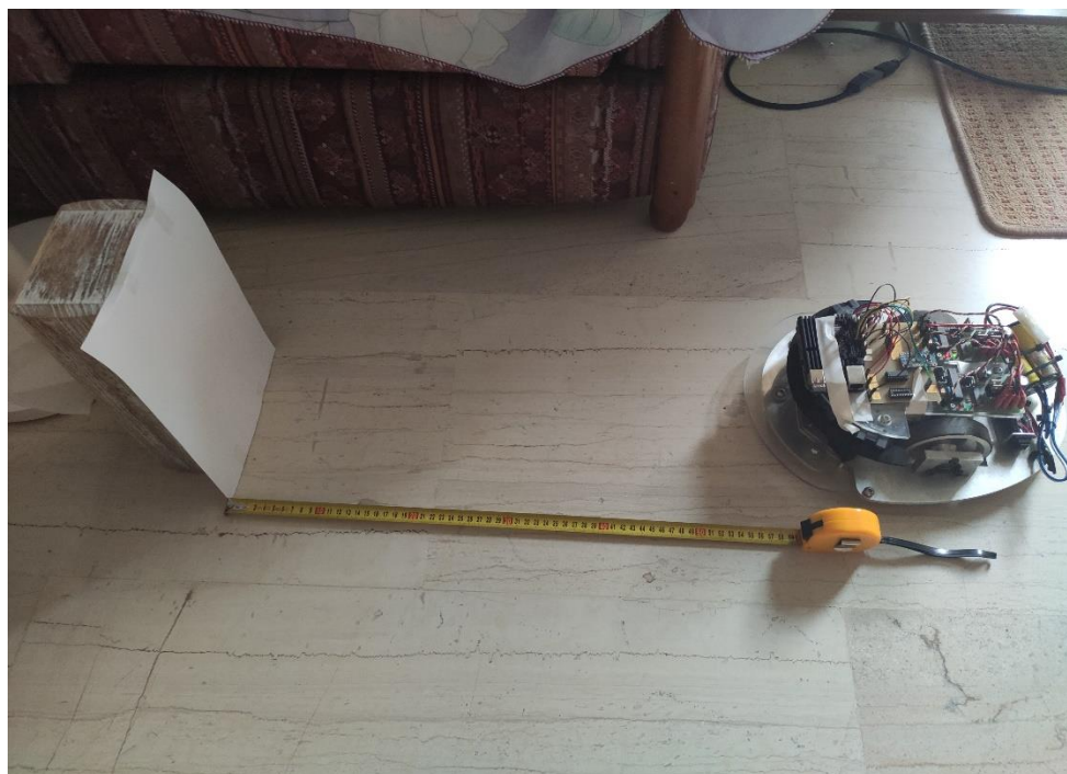
Εικόνα 60: Έλεγχος των αισθητήρων μέτρησης απόστασης (part 3)
