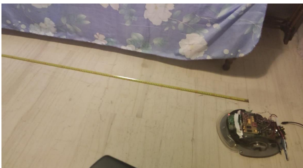
Εικόνα 57: Πειραματική μέτρηση της ταχύτητας βάσης σε m/s
