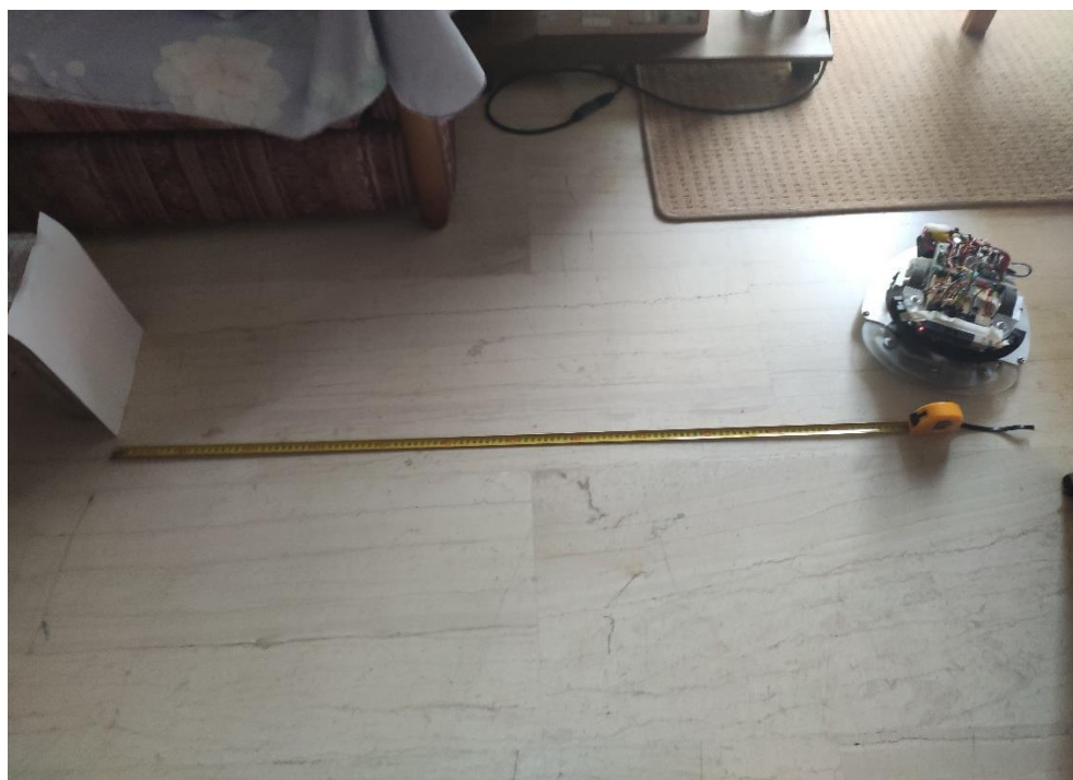
Εικόνα 58: Έλεγχος των αισθητήρων μέτρησης απόστασης (part 1)
