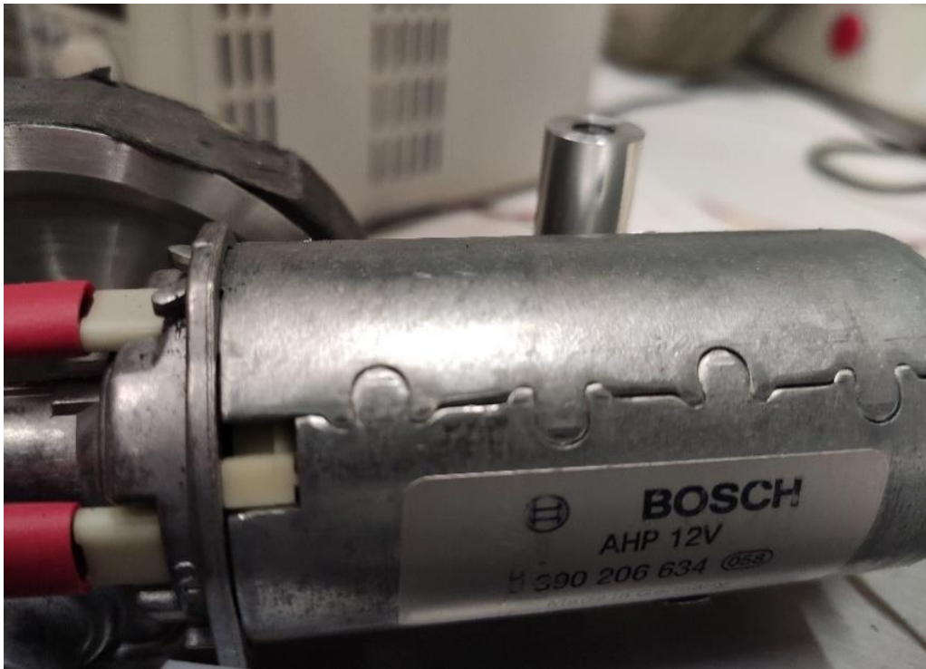
Εικόνα 12: Μοτέρ τροχού 12V
