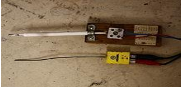
Σχήμα 1.2 Θερμοζεύγος για μέτρηση υψηλής θερμοκρασίας
