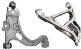
Σχήμα 4.31: Βραχίονες ελέγχου συστήματος ανάρτησης οχήματος γενικής χρήσης [79]
