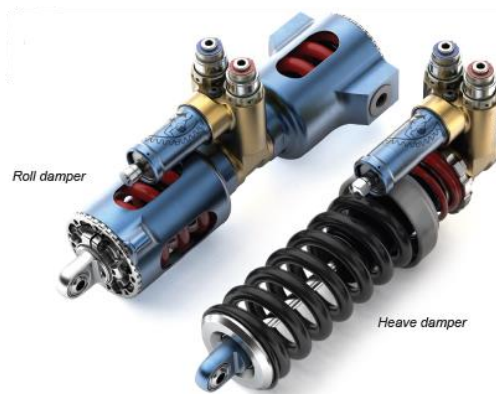
Σχήμα 3.22: Στοιχεία δυσκαμψίας και απόσβεσης κλυδωνισμού και κατακόρυφης μετατόπισης – Multimatic Inc. [54]
