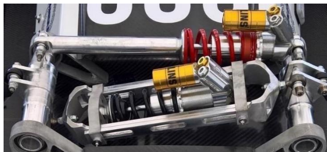
Σχήμα 3.23: Υλοποίηση μηχανισμού επενέργησης για την απόζευξη της κατακόρυφης δυσκαμψίας και της δυσκαμψίας κλυδωνισμού άξονα – HAWKS Racing Formula SAE
