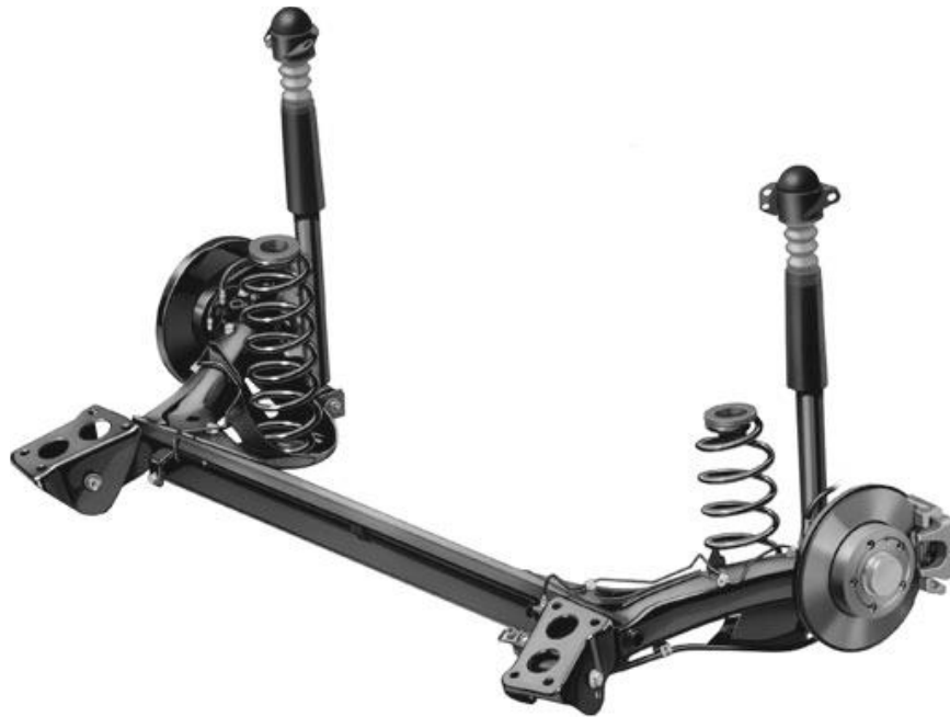
Σχήμα 2.1: Σύστημα ανάρτησης ημιάκαμπτου άξονα [5]
