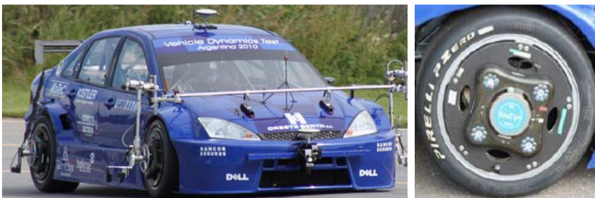
Σχήμα 2.58: Προσδιορισμός χαρακτηριστικών K&C εν κινήσει [43]
