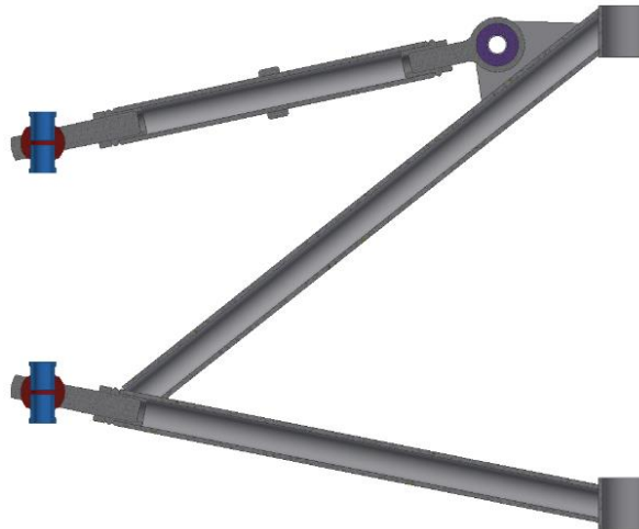
Σχήμα 3.29: Έδραση ράβδου συγκράτησης τροχού επί του βραχίονα ελέγχου
