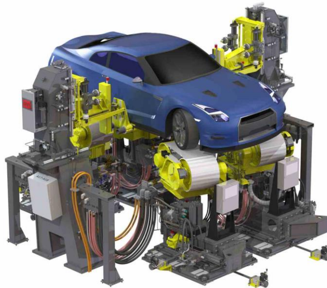
Σχήμα 2.57: Πειραματική διάταξη για εργαστηριακή προσομοίωση της πλήρους δυναμικής οχήματος [41]
