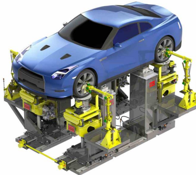
Σχήμα 2.53: Πειραματική διάταξη K&C της εταιρείας MTS Systems [35]
