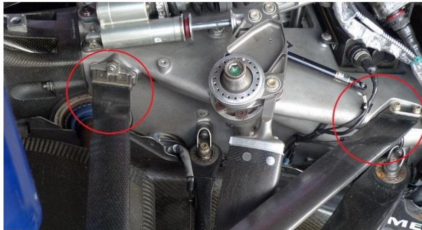
Σχήμα 2.41: Ανάρτηση διπλών ψαλιδιών πίσω άξονα αγωνιστικού οχήματος χωρίς σφαιρικά έδρανα [32]
