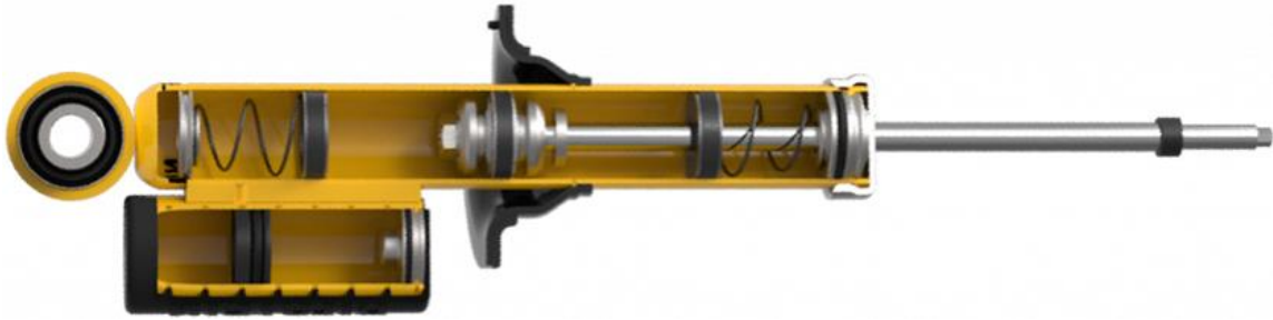
Σχήμα 4.24: Σχηματική απεικόνιση τυπικού αποσβεστήρα για εφαρμογές οχημάτων [75]
