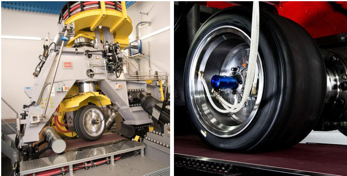
Σχήμα 2.18: Πειραματικές διατάξεις προσδιορισμού δυναμικών χαρακτηριστικών ελαστικών επισώτρων [11], [12]
