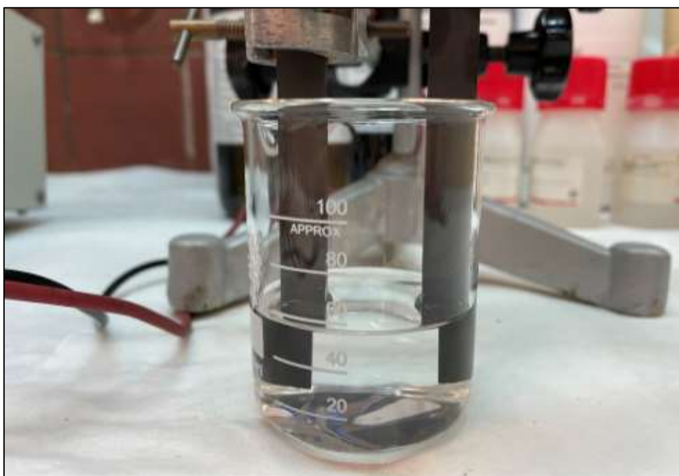
Εικόνα 3.3: Η τοποθέτηση των ράβδων γραφίτη στο διάλυμα του ηλεκτρολύτη.
