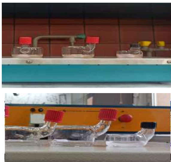
Εικόνα 3.58: Τα δείγματα TCPP-TiO 2 , THPP-TiO 2 , TiO 2 πριν (πάνω) και μετά (κάτω) τη φωτοκατάλυση.
