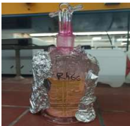
Εικόνα 3.32: Παρασκευή διαλύματος ρύπου ροδαμίνης 6G συγκέντρωσης 3ppm.
