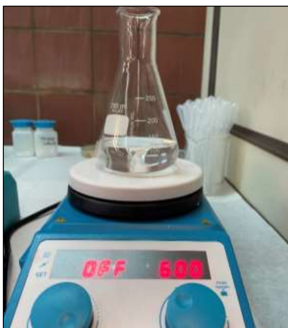
Εικόνα 3.1: Παρασκευή του αλκαλικού διαλύματος ηλεκτρολύτη.
