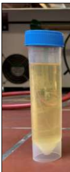
Εικόνα 3.4: Διάλυμα ηλεκτρολύτη-CQDs που προέκυψε μετά την επιβολή ρεύματος 30 mA.
