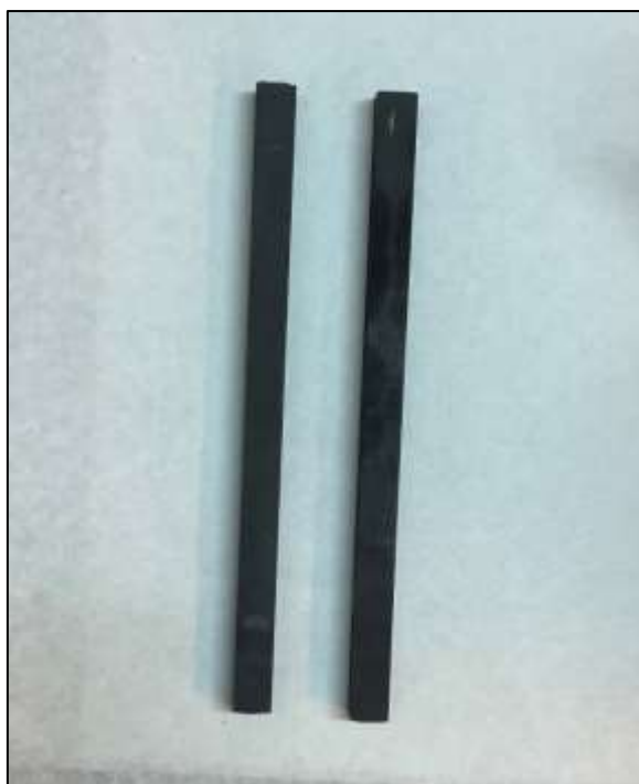
Εικόνα 3.2: Οι ράβδοι γραφίτη που αποτέλεσαν τα ηλεκτρόδια (άνοδο και κάθοδο) για την ηλεκτροχημική σύνθεση των κβαντικών τελειών άνθρακα.
