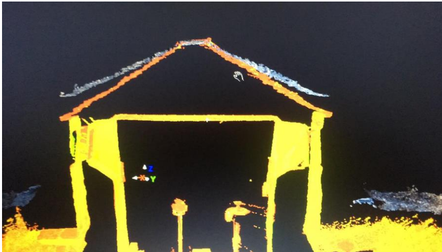
Εικόνα 6.3 – Σφάλμα στη στέγη από τη λήψη του drone
