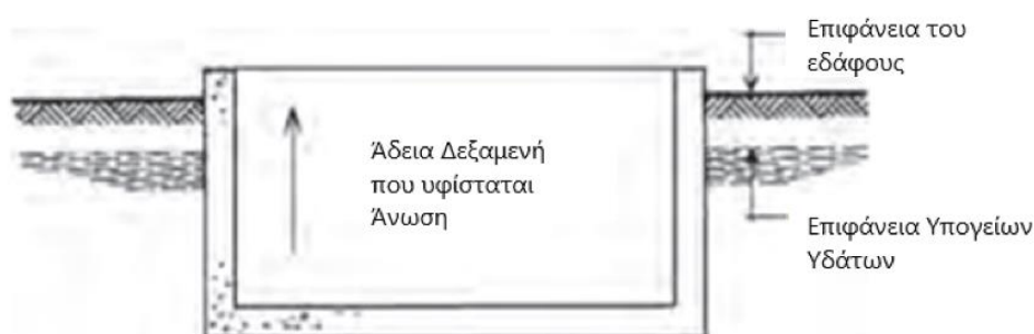
Σχήμα 1.5 Άνωση δεξαμενών λόγω υπόγειων υδάτων.
