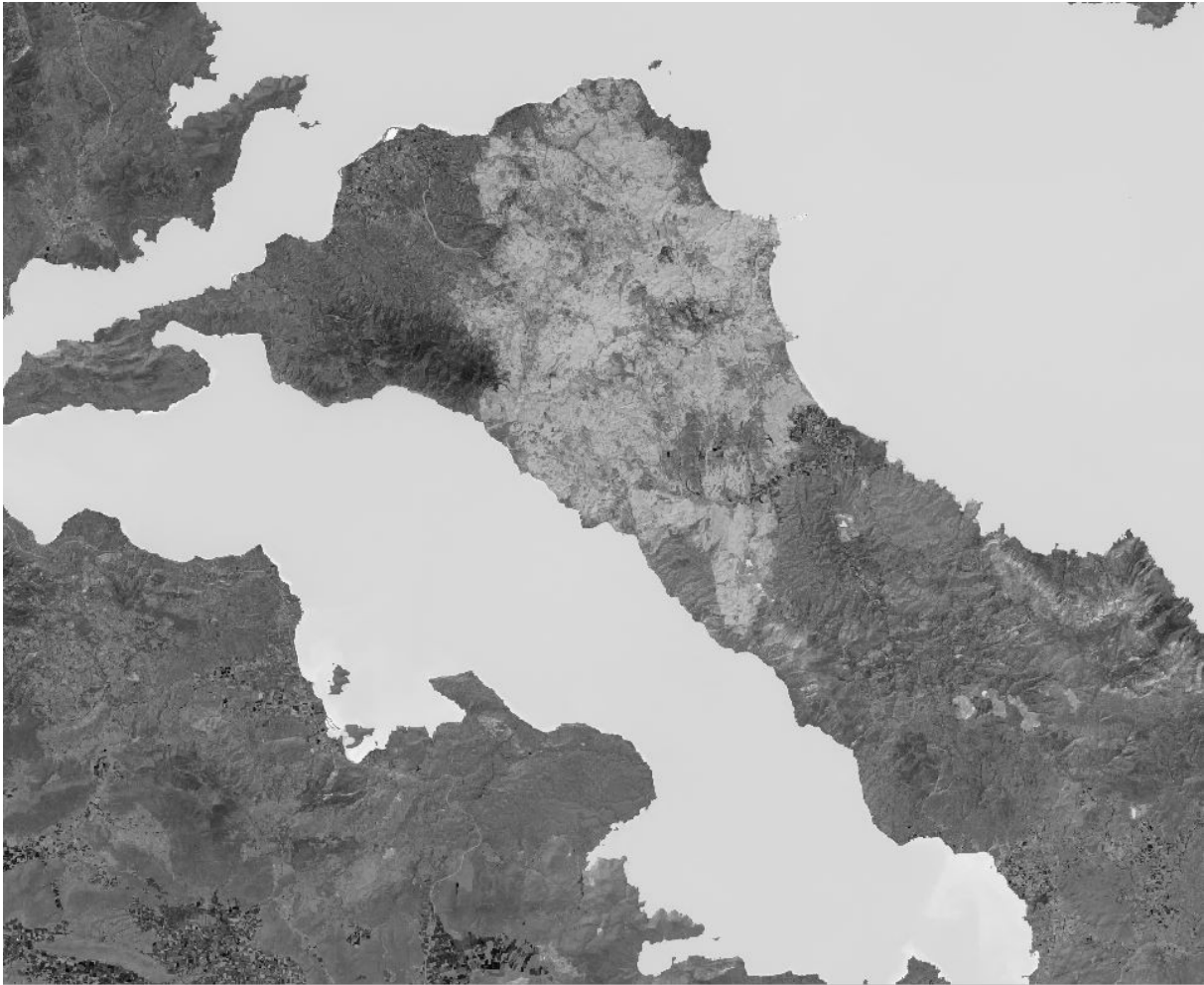
Σχήμα Δ.1: Απόσπασμα αεροφωτογραφίας από το δορυφόρο Sentinel, με εφαρμογή του δείκτη NDWI για ανάδειξη καμένης έκτασης ( Α/Φ από Σεπτέμβριο 2021).
