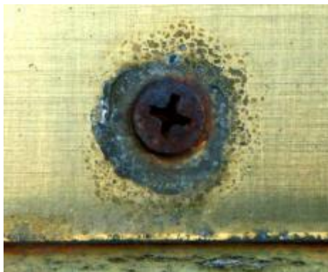
Εικόνα 4-5: Γαλβανική Διάβρωση περί μίας οπής
