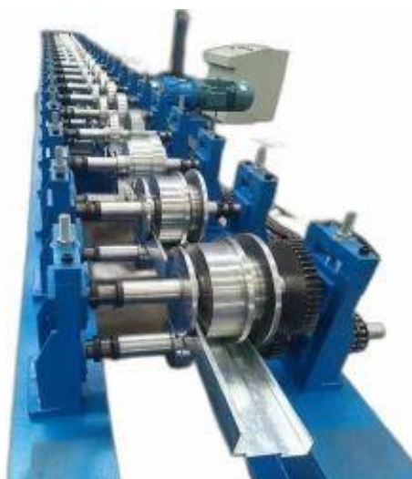
Εικόνα 2-3: Τυποποιημένη μηχανή έλασης
