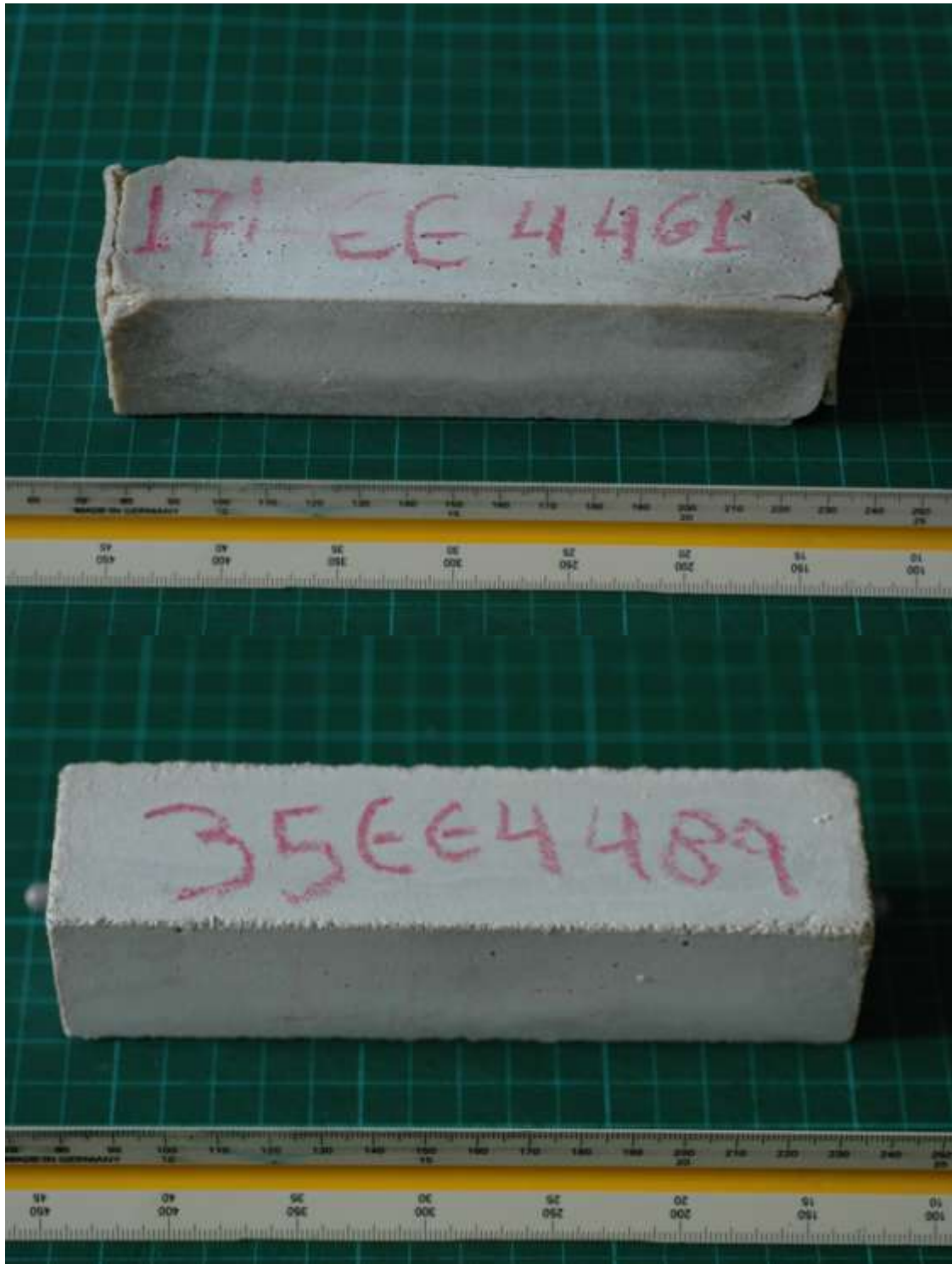
Εικόνα 6: Δείγμα 17 0%LL, Δείγμα 35 15%LL σε διάλυμα \text{Na}_2\text{SO}_4/\text{NaCl} στους 50^\circ\text{C} για 90 ημέρες.
