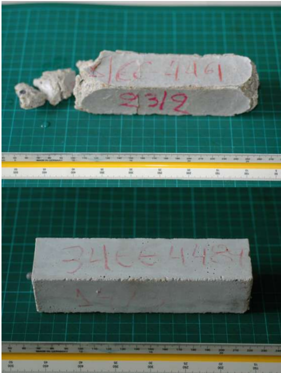
Εικόνα 3: Δείγμα 18 0%LL, Δείγμα 34 15%LL σε διάλυμα \text{Na}_2\text{SO}_4/\text{NaCl} 20°C για 90 ημέρες
