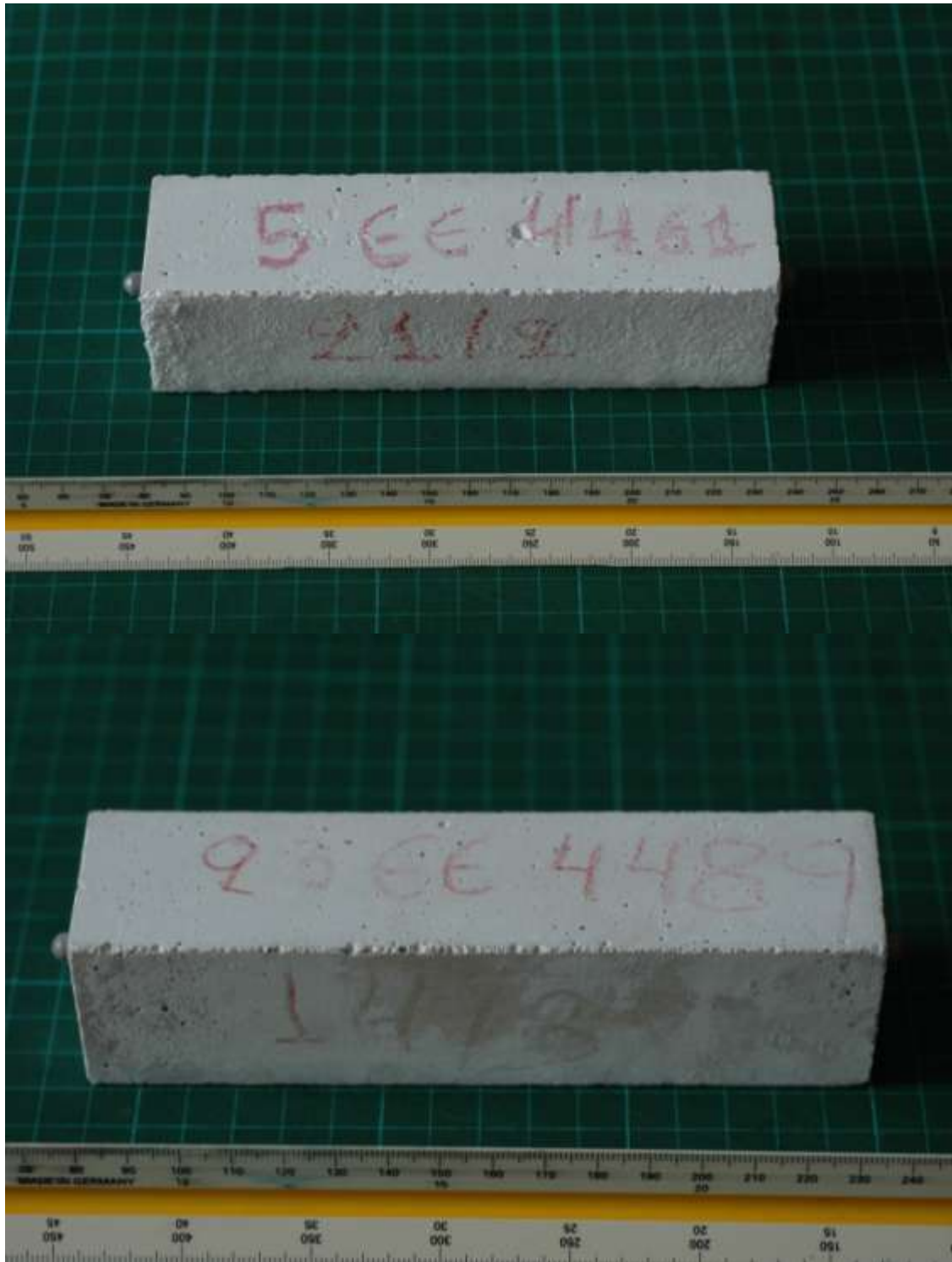
Εικόνα 4: Δείγμα 5 0%LL, Δείγμα 23 15%LL σε διάλυμα \text{Ca(OH)}_2 στους 50^\circ\text{C} για 90 ημέρες.
