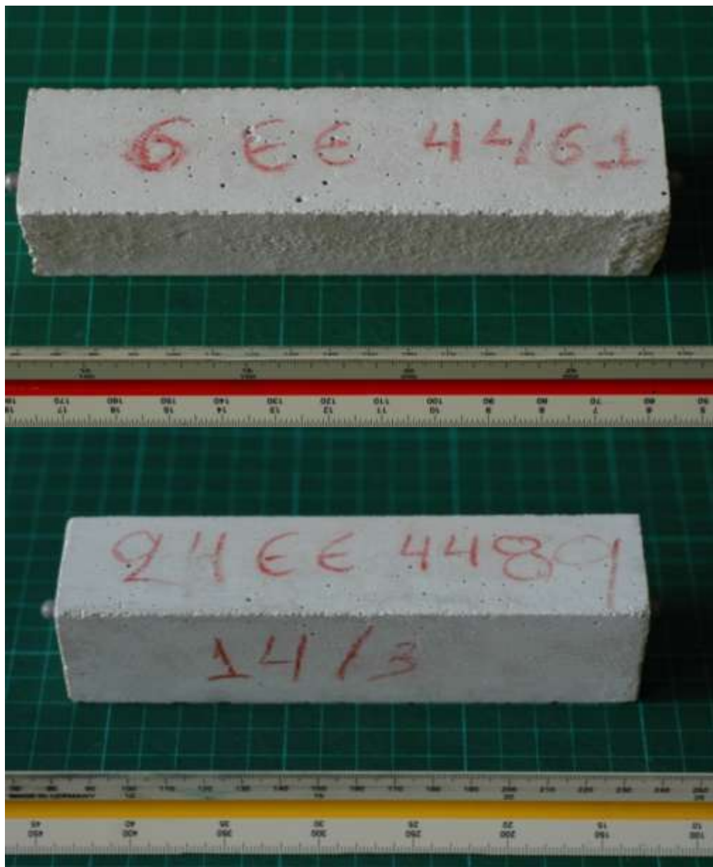
Εικόνα 1: Δείγμα 6 0%LL, Δείγμα 24 15%LL σε διάλυμα \text{Ca}(\text{OH})_2 στους 20oC για 90 ημέρες.
