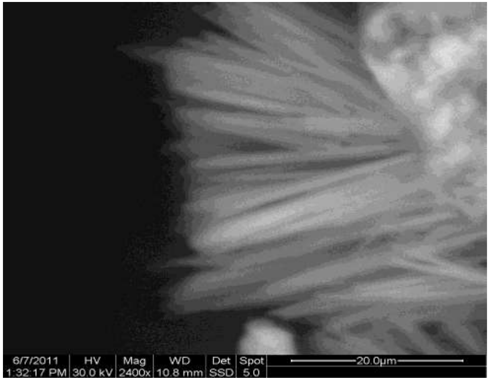
Σχήμα 64 : Δείγμα 15%LLσε διάλυμα 5%Na 2 SO 4 /5%NaCl 50°C για 56 ημέρες
