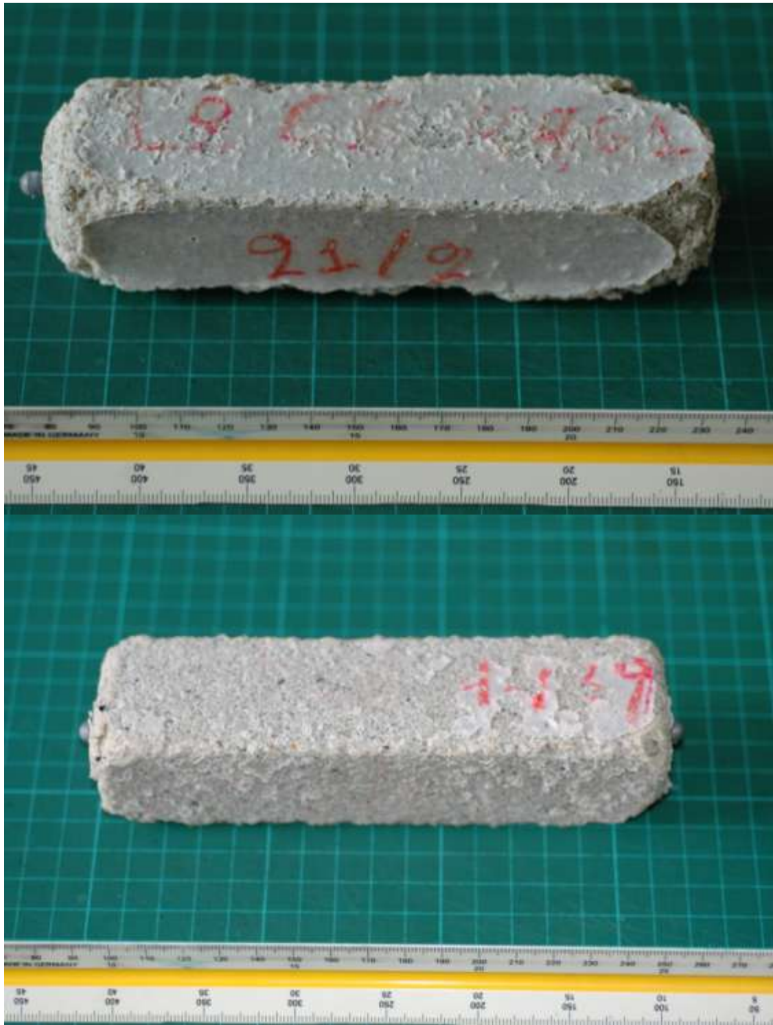
Εικόνα 2: Δείγμα 12 0%LL, Δείγμα 28 15%LL σε διάλυμα \text{Na}_2\text{SO}_4 στους 20oC για 90 ημέρες.
