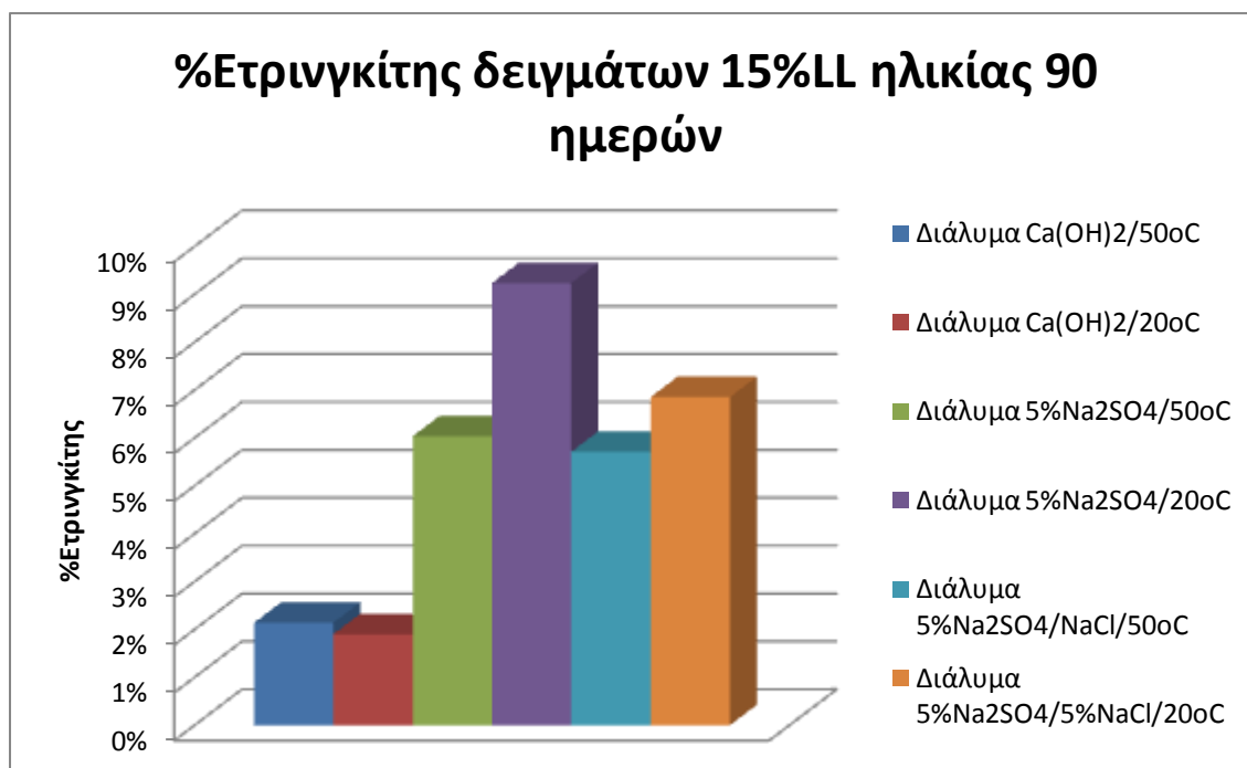
Σχήμα 32 :%Ετρινγκίτης δειγμάτων 15%LL για δείγματα ηλικίας 90 ημερών.
