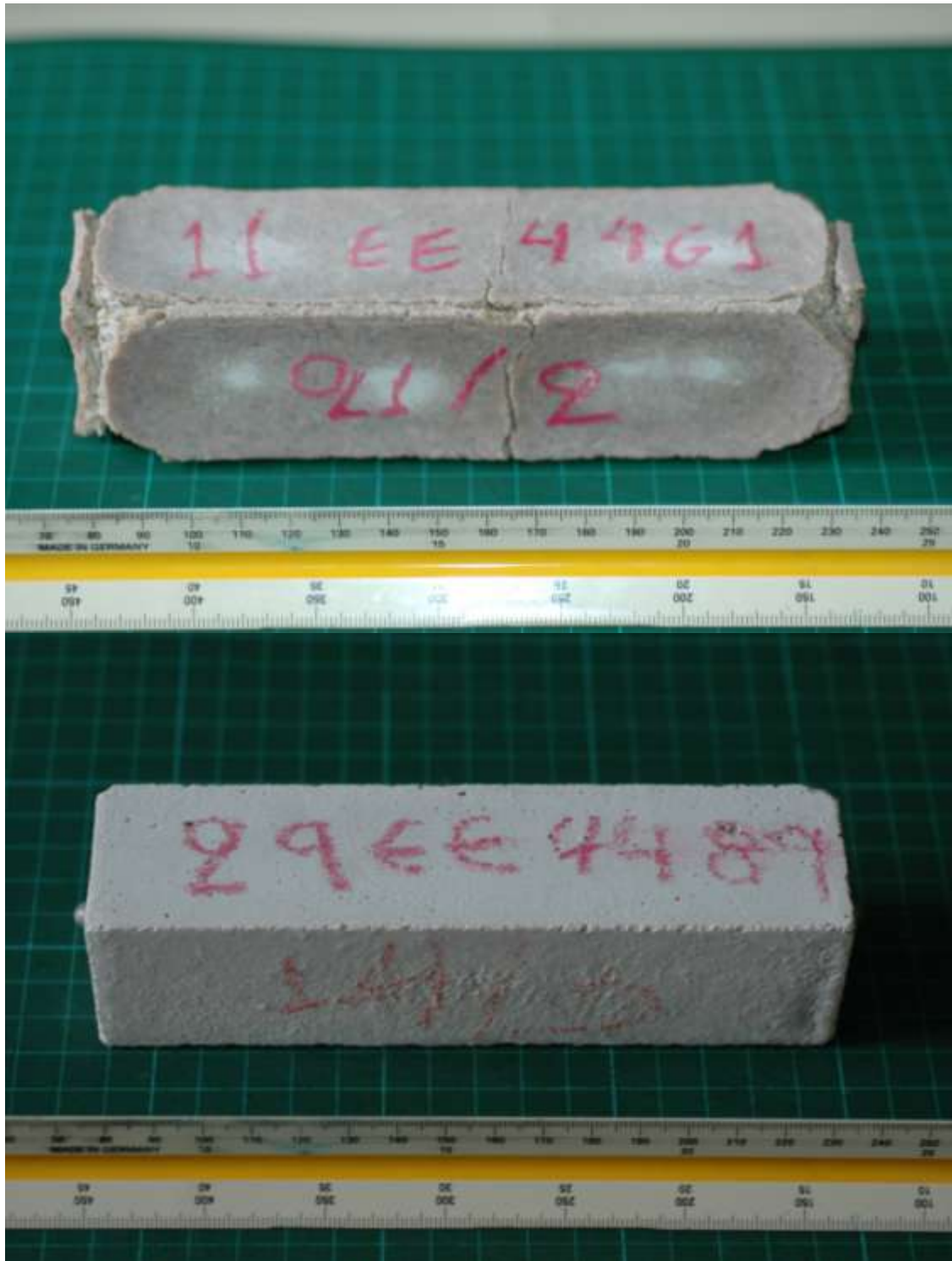
Εικόνα 5: Δείγμα 11 0%LL , Δείγμα 29 15%LLσε διάλυμα \text{Na}_2\text{SO}_4 στους 50^\circ\text{C} για 90 ημέρες.
