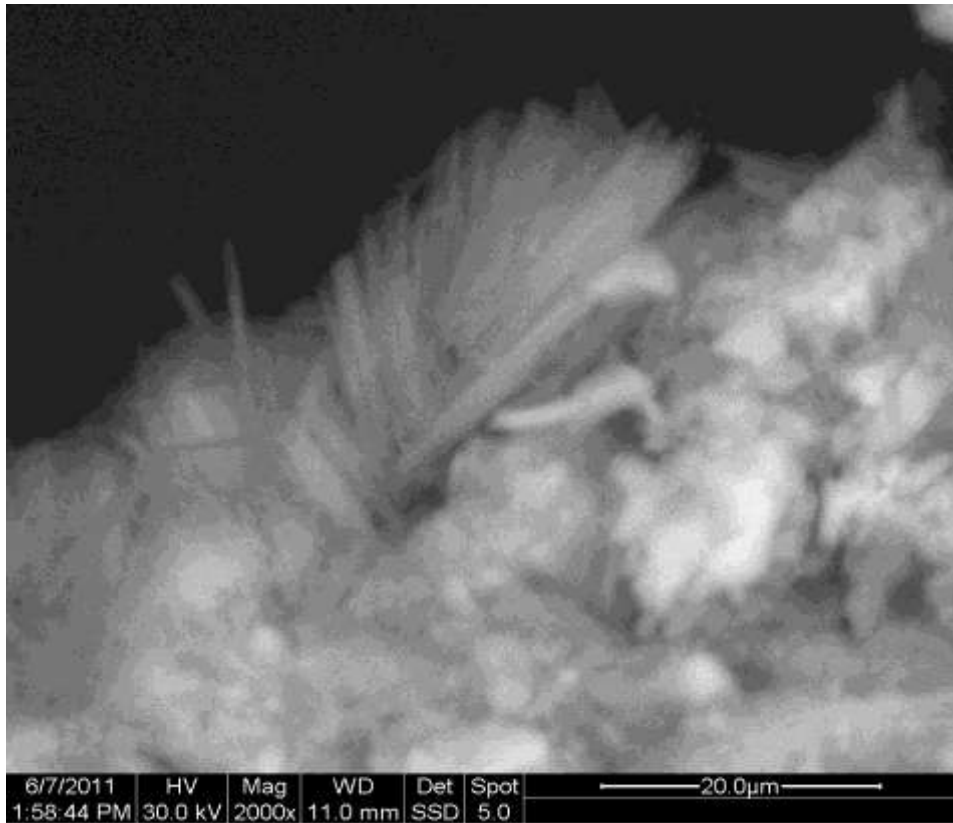
Σχήμα 56: Δείγμα 15%LL σε διαλύμα 5%Na 2 SO 4 50°C για 56 ημέρες
