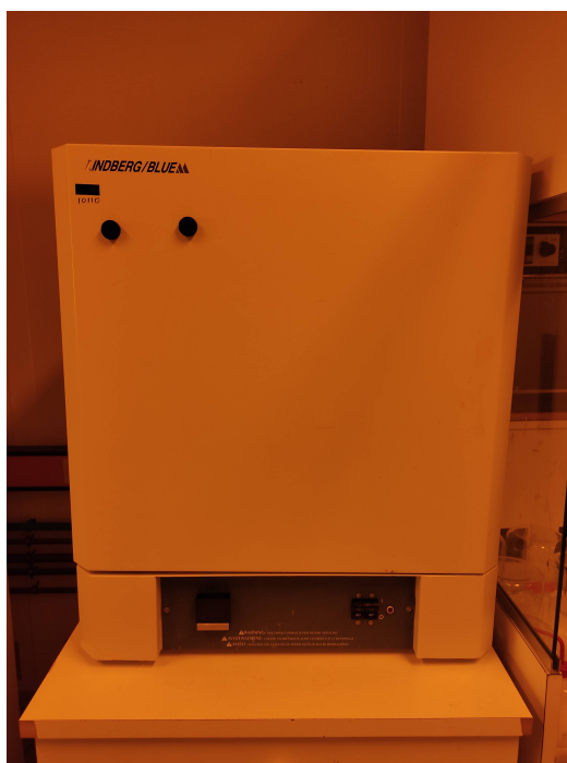
Σχήμα 55: Φούρνος για θερμική ανόπτηση υλικών με μέγιστη θερμοκρασία 1100°C.
