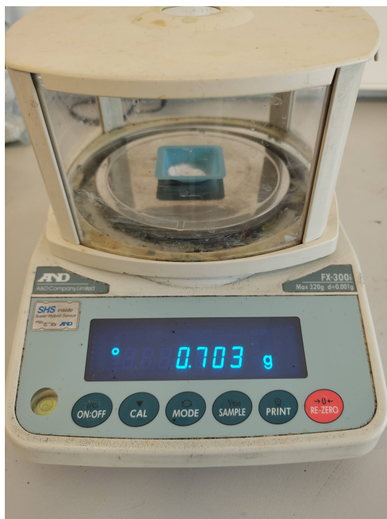
Σχήμα 19: Ζύγιση ένυδρου οξικού ψευδαργύρου για την παρασκευή του e-gel.
