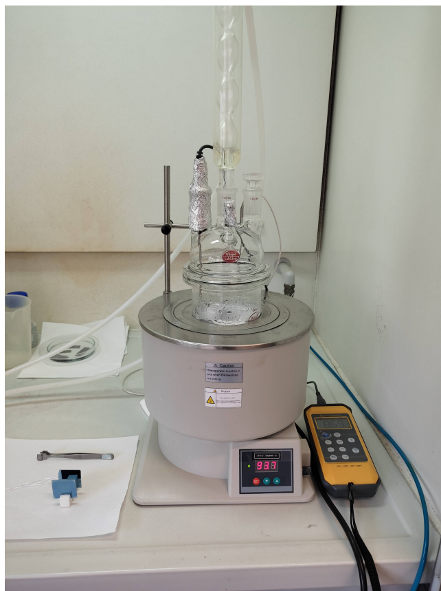
Σχήμα 21: Πειραματική διάταξη ανάπτυξης νανοδομών ZnO με την διαδικασία της υδροθερμικής μεθόδου.
