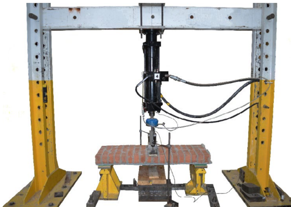
Σχ 4. 1 Πραγματικό πείραμα κάμψης 3 σημείων (Kariou et al., 2018)
