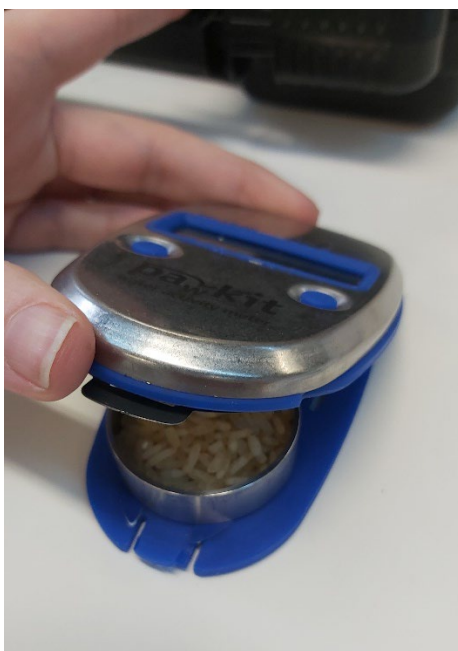
Εικόνα 16: Μέτρηση aw δείγματος ρυζιού με συσκευή Decagon.
