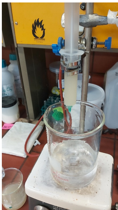
Εικόνα 11: Έγχυση υδροπηκτικής φορέα/πυρήνα με σύριγγα σε αιθανόλη για σχηματισμό μικροκαψουλών
