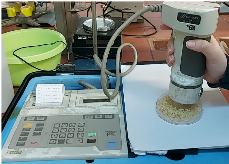
Εικόνα 14 Μέτρηση χρώματος σε δείγμα ρυζιού με χρήση χρωματόμετρου CR-200
