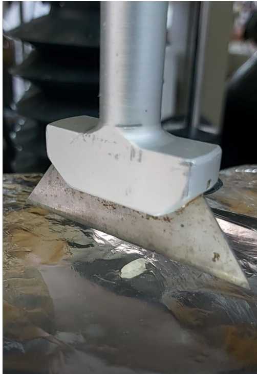
Εικόνα 15: Ανάλυση υφής δείγματος ρυζιού με στέλεχος TA-45
