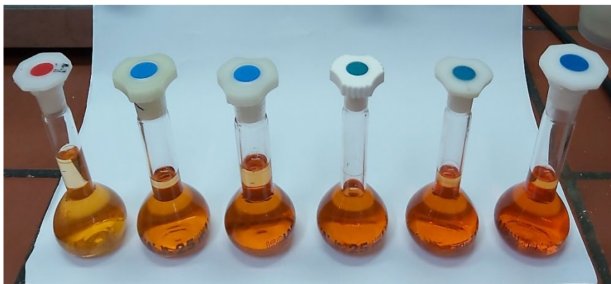
Εικόνα 12: Διαλύματα γνωστής συγκέντρωσης σε αύξουσα σειρά περιεκτικότητας σε Σίδηρο.
