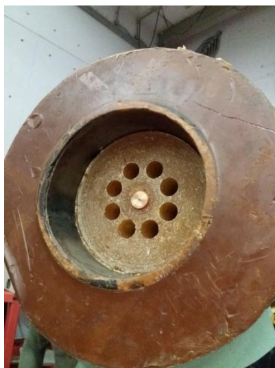
Εικόνα 16 : Ο ανιχνευτής \text{BF}_3 στο κέντρο μέσα σε έναν κύλινδρο παραφίνης
