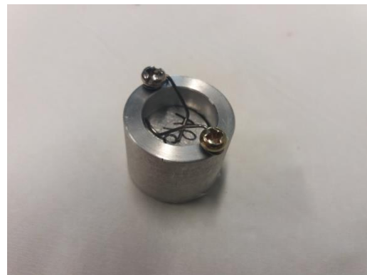
Εικόνα 15: Η βάση (holder) με τον στόχο Hg (αριστερά) και με όλους τους στόχους (δεξιά) έτοιμο για ακτινοβολήση
