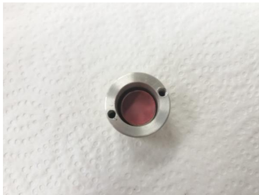
Εικόνα 15: Η βάση (holder) με τον στόχο Hg (αριστερά) και με όλους τους στόχους (δεξιά) έτοιμο για ακτινοβολήση
