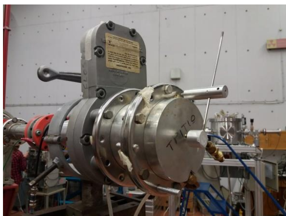
Εικόνα 10: Η βάση (holder) με τους στόχους μπροστά από το στόχο τρίτιου
