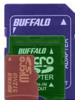
Εικόνα 2.3.1β Σύγκριση μεγέθους SD, miniSD, microSD
