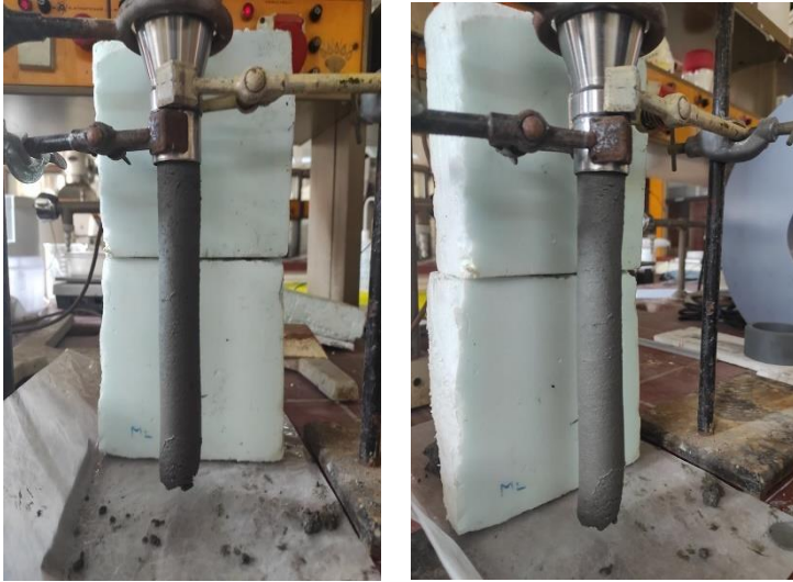
Σχήμα 5.6 Σύνθεση με λόγο S/B : 1.9 κατά τη διαδικασία της εξώθησης.
