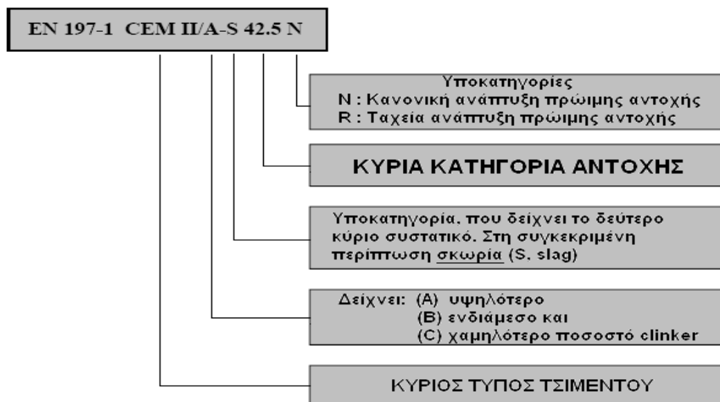
Σχήμα 2.2: Συμβολισμός των διαφόρων τύπων τσιμέντου του ευρωπαϊκού προτύπου.
