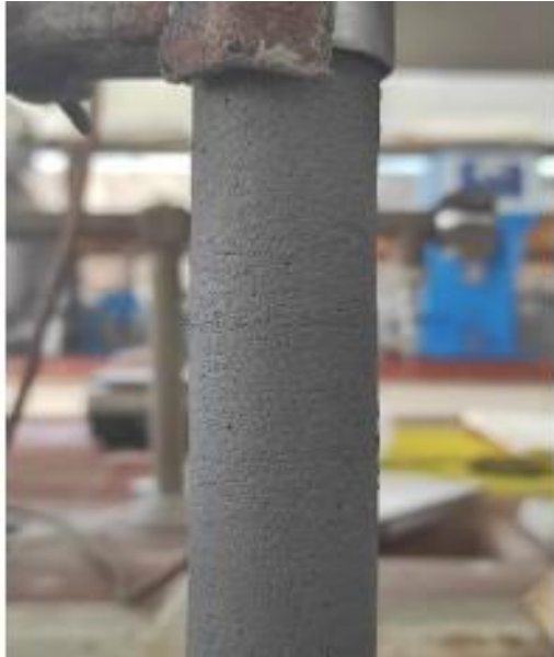
Σχήμα 5.25: α) Σύνθεση 4 η με προσθήκη 1% επιταχυντή κατά τη διαδικασία της εξώθησης. β) Σύνθεση 5 η με προσθήκη 1.25% επιταχυντή κατά τη διαδικασία της εξώθησης.
