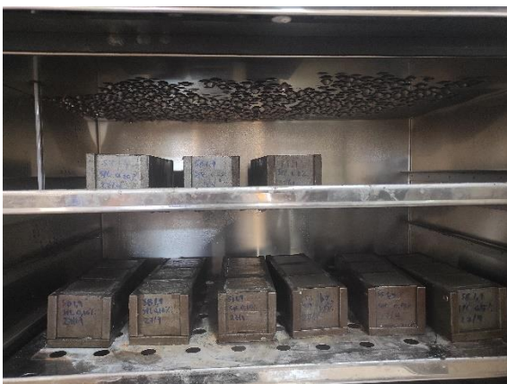
Σχήμα 4.10: Μεταλλικές μήτρες με νωπό τσιμεντοκονίαμα τοποθετημένες σε θάλαμο συντήρησης με σταθερές συνθήκες θερμοκρασίας και υγρασίας.
