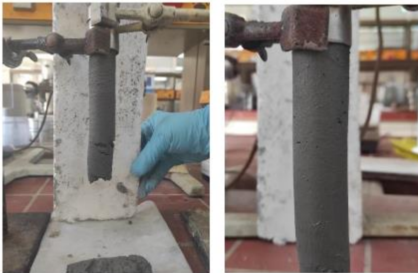
Σχήμα 5.11: α) Σύνθεση 1 η με προσθήκη 0.05% υπερρυστοποιητή κατά τη διαδικασία της εξώθησης. β) Σύνθεση 3 η με προσθήκη 0.15% υπερρυστοποιητή κατά τη διαδικασία της εξώθησης.
