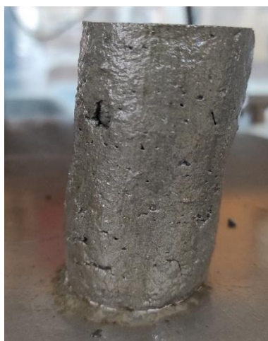
Σχήμα 5.16: Παραμόρφωση υλικού με προσθήκη ποσοστού 0.75% κ.β. επιβραδυντή.
