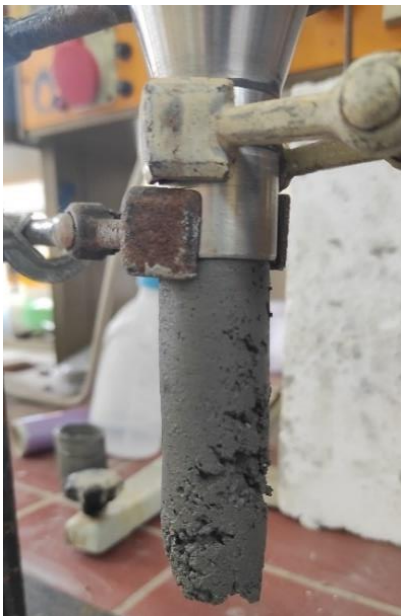
Σχήμα 5.7 Σύνθεση με λόγο S/B:2.3 κατά τη διαδικασία της εξώθησης.
