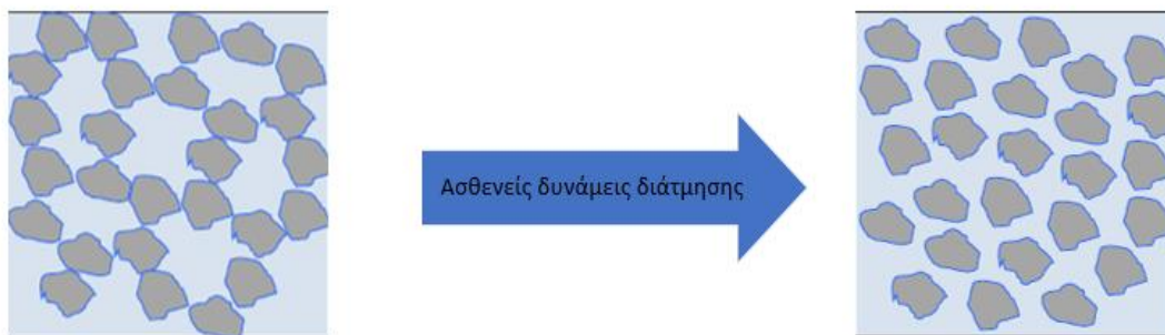
Σχήμα 2.5: Τρόπος επίδρασης του υπερρυστοποιητή.
