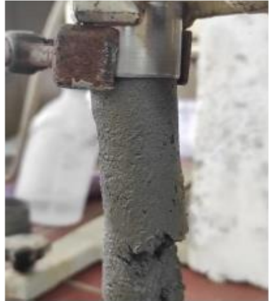
Σχήμα 5.25: α) Σύνθεση 4 η με προσθήκη 1% επιταχυντή κατά τη διαδικασία της εξώθησης. β) Σύνθεση 5 η με προσθήκη 1.25% επιταχυντή κατά τη διαδικασία της εξώθησης.
