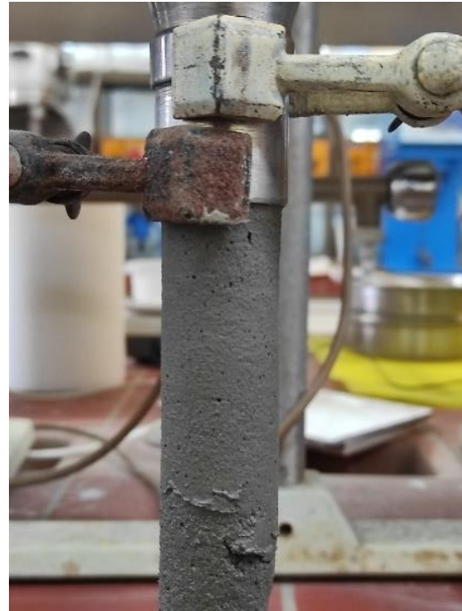
Σχήμα 5.19: Σύνθεση 5 η με προσθήκη 1.25% επιβραδυντή κατά τη διαδικασία της εξώθησης.
