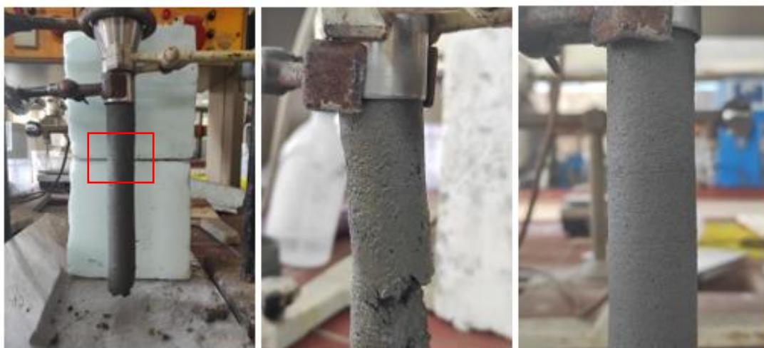
Σχήμα 4.6: α) Λαιμός κατά την εξώθηση. β) Έντονες ρωγμές και δυσκολία εξώθησης. γ) Καλή εικόνα εξώθησης.
