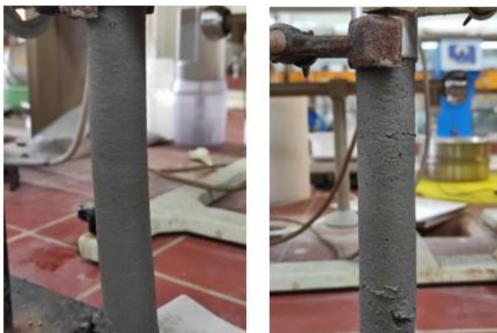
Σχήμα 5.24: α) Σύνθεση 1 η με προσθήκη 0.25% επιταχυντή κατά τη διαδικασία της εξώθησης. β) Σύνθεση 2 η με προσθήκη 0.50% επιταχυντή κατά τη διαδικασία της εξώθησης.
