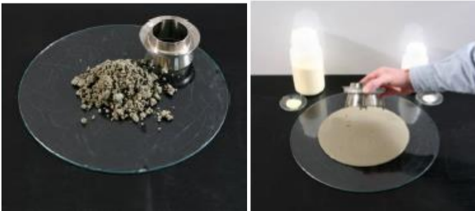
Σχήμα 2.3: α) Τσιμέντο και προσθήκη νερού. β) Τσιμέντο με προσθήκη νερού και υπερρευστοποιητή.
