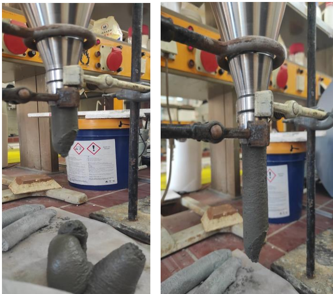
Σχήμα 5.5: Σύσταση με λόγο S/B: 1.4 κατά τη διαδικασία της εξώθησης.
