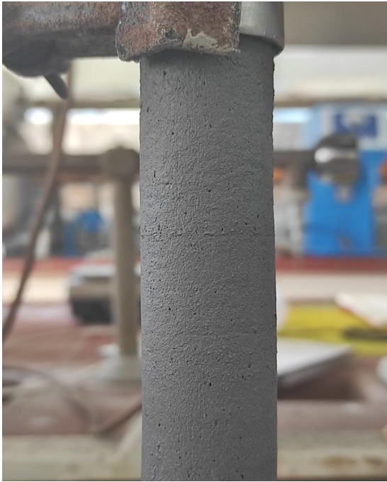
Σχήμα 5.18: Σύνθεση 4 η με προσθήκη 1% επιβραδυντή κατά τη διαδικασία της εξώθησης.
