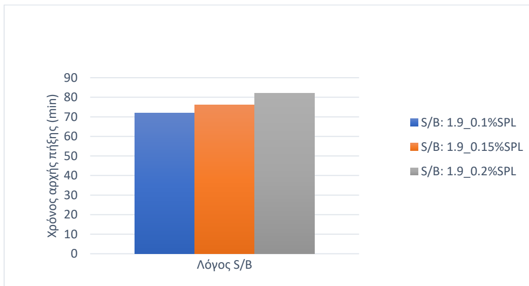
Σχήμα 5.12: Διάγραμμα χρόνου αρχής πήξης για τις τρεις συνθέσεις με την προσθήκη υπερρυστοποιητή.
