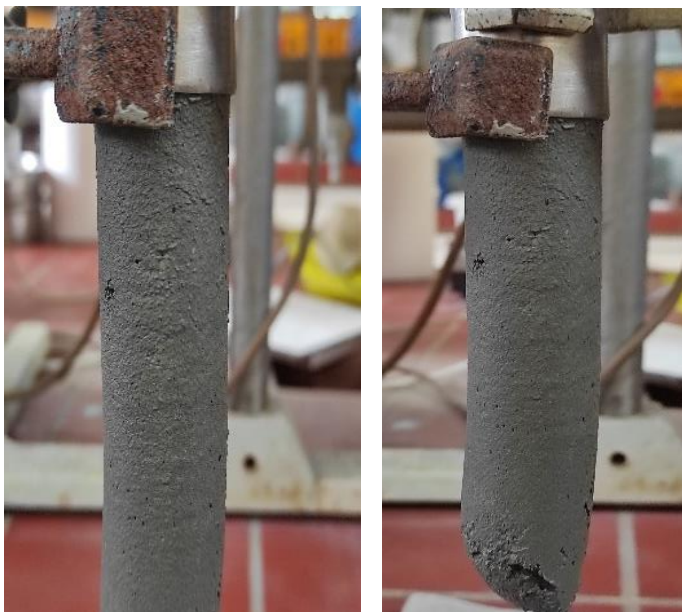
Σχήμα 5.17: Σύνθεση 3 η με προσθήκη 0.75% επιβραδυντή. κατά τη διαδικασία της εξώθησης.
