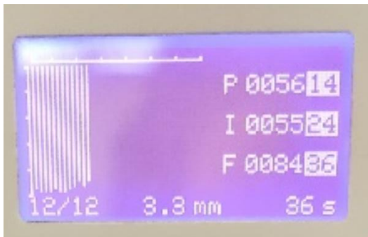
Σχήμα 4.8: Οθόνη καταγραφής ρυθμού διείδυσης βελόνας συναρτήσεϊ του χρόνου.
