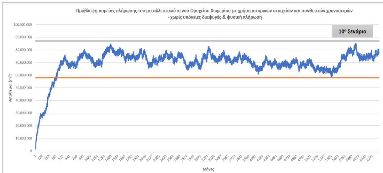
Εικόνα 71. Πορεία πλήρωσης με νερό του κενού του Ορυχείου Χωρεμίου με εισροές επιφανειακές απορροές και βροχοπτώσεις στην περίπτωση που δεν υφίσταται υπόγεια διαφυγή νερού - Εξέταση ιστορικών στοιχείων και συνθετικών χρονοσειρών (σύνολο 533 έτη)
