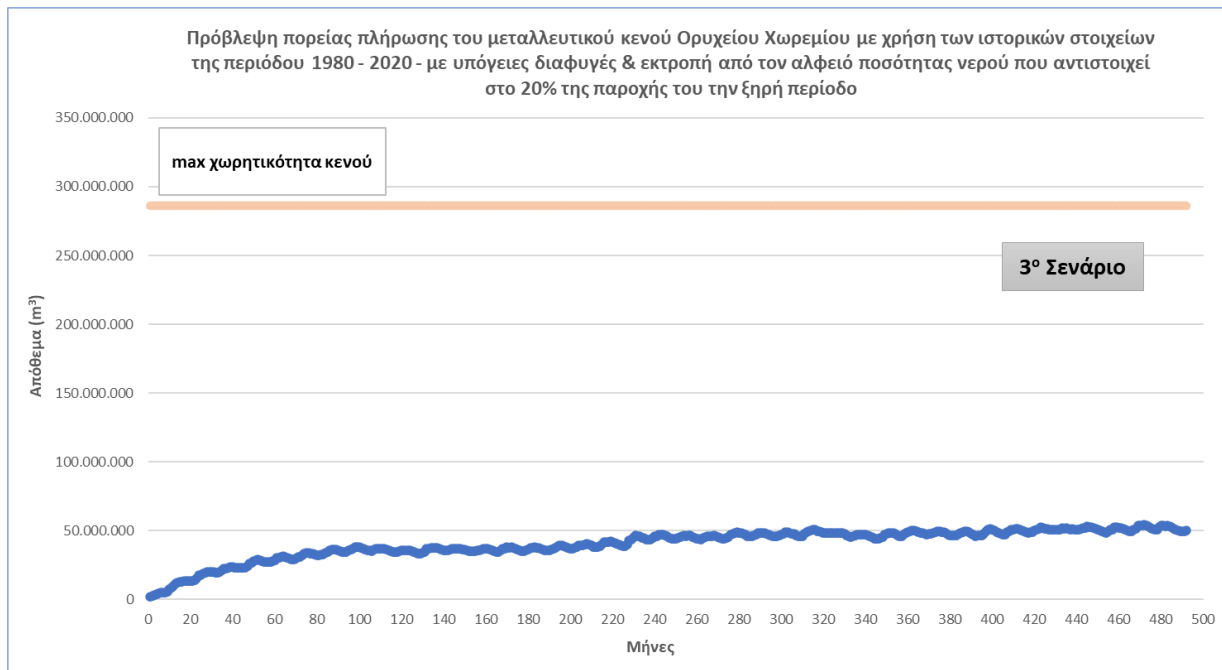
Εικόνα 75. Πορεία πλήρωσης με νερό του κενού του Ορυχείου Χωρεμίου με εκτροπή από τον Αλφειό ποσότητα νερού ίση με το 20% της παροχής του ποταμού την ξηρή περίοδο στην περίπτωση υπόγειας διαφυγής νερού - Εξέταση ιστορικών στοιχείων (41 έτη)
