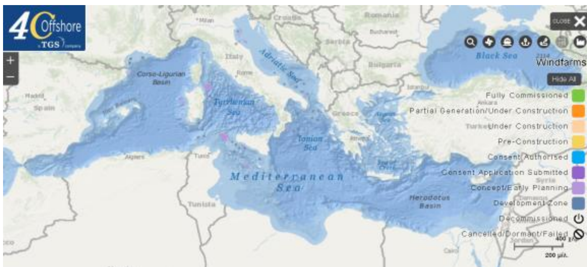
Εικόνα 4.2. Χάρτης με πιθανές θέσεις εγκατάστασης υπεράκτιων αιολικών πάρκων στη Μεσόγειο θάλασσα. [22] [Πηγή: https://map.4coffshore.com/offshorewind/ ]
