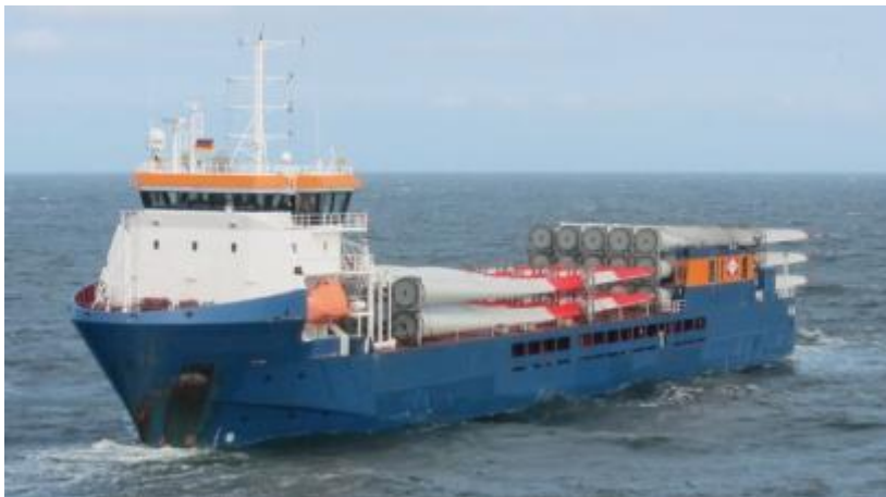
Εικόνα 2.6. Τυπικό σκάφος Υποστηρικτικής Τροφοδοσίας [FSV]. [14]
