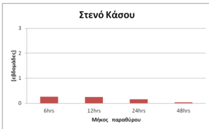
Σχήμα 5.90. Ιστόγραμμα συνολικής διάρκειας (σε εβδομάδες) για τη μη πρόσβαση των σκαφών σε διαφορετικά μήκη μετεωρολογικών παραθύρων (6hrs, 12hrs, 24hrs και 48hrs), για την τοποθεσία του OWF: Στενό Κάσου.
