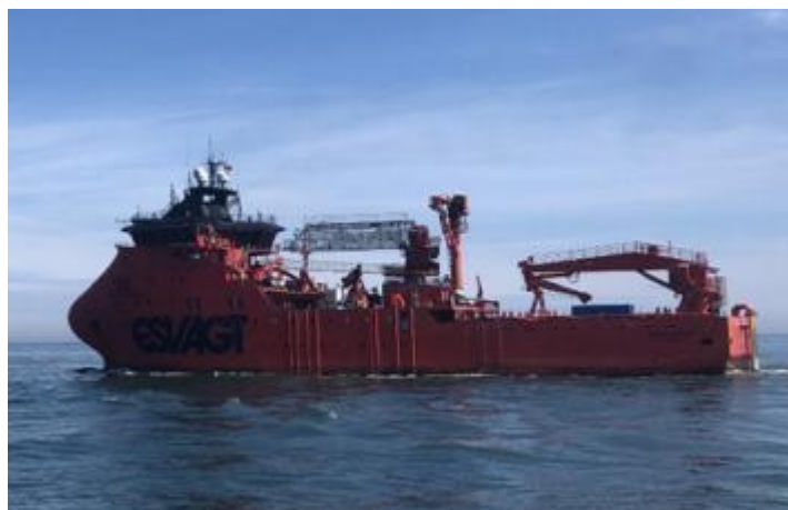
Εικόνα 2.5. Τυπικό σκάφος Λειτουργικών Υπηρεσιών [SOV]. [13]
