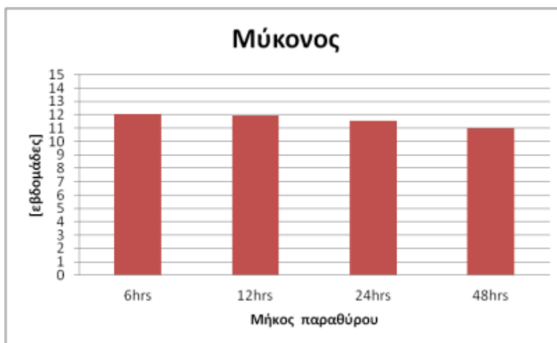
Σχήμα 5.84. Ιστόγραμμα συνολικής διάρκειας (σε εβδομάδες) για τη μη πρόσβαση των σκαφών σε διαφορετικά μήκη μετεωρολογικών παραθύρων (6hrs, 12hrs, 24hrs και 48hrs), για την τοποθεσία του OWF: Μύκονος.
