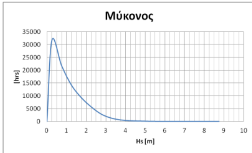
Σχήμα 5.74. Συχνότητα εμφάνισης του χαρακτηριστικού ύψους κύματος ( H_s ) για το OWF: Μύκονος.
