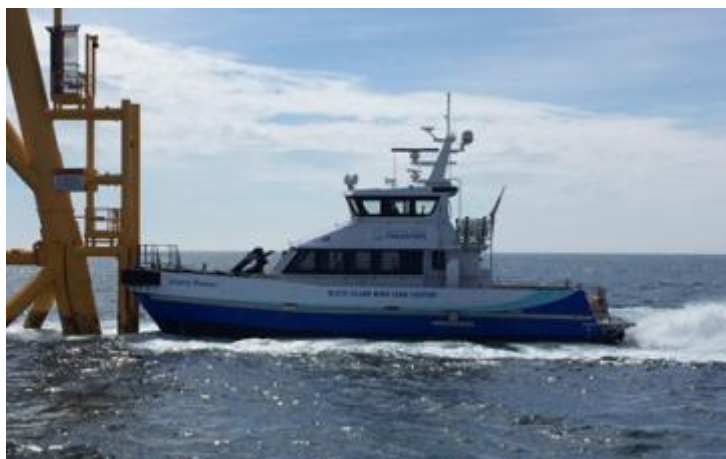
Εικόνα 2.4. Τυπικό σκάφος Μεταφοράς Πληρώματος [CTV]. [13]
