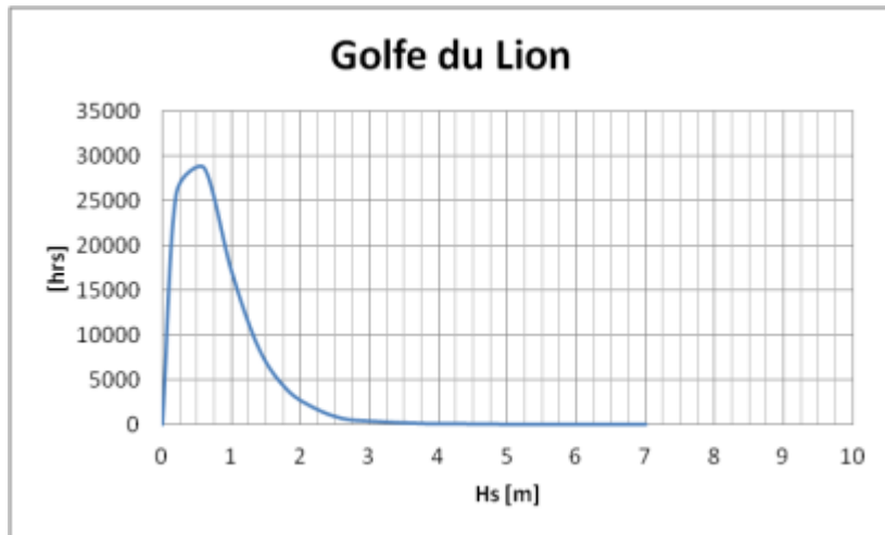
Σχήμα 5.1. Συχνότητα εμφάνισης του χαρακτηριστικού ύψους κύματος (Hs) για το OWF: Golfe du Lion.
