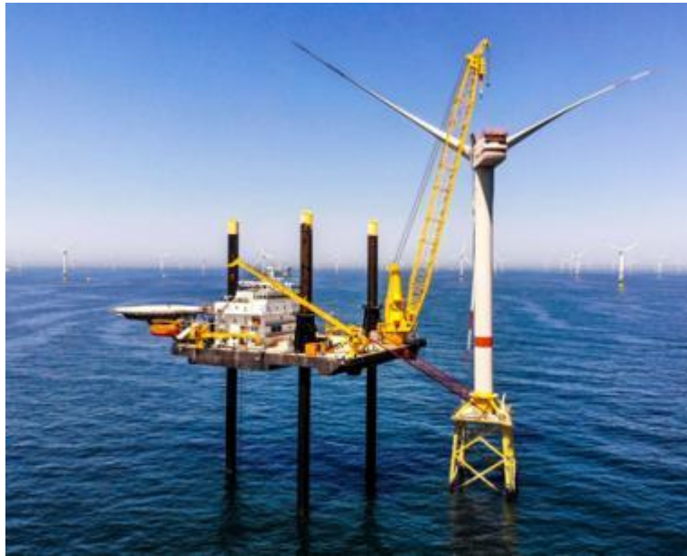
Εικόνα 2.8. Τυπικό Ανυψωτικό Πλοίο (Liftboats). [13]
