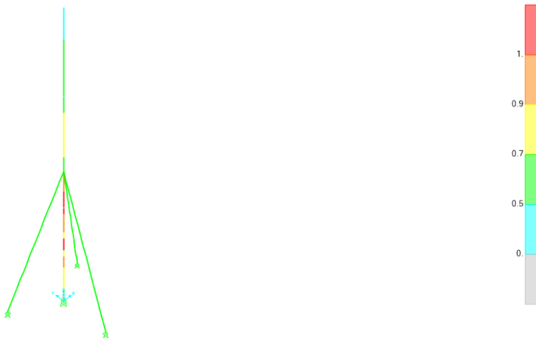
Εικόνα 3-1: Καλωδιωτός Πυλώνας Ανεμογεννήτριας με γωνία πρόσδεσης 20ο
