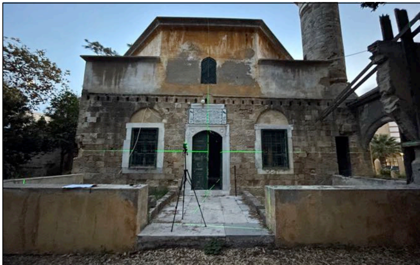
Οριζόντιο επίπεδο (E1) με την χρήση περιστροφικού λέιζερ στις όψεις του τεμένους
