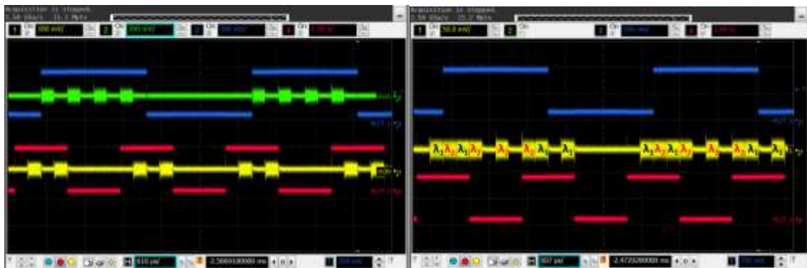
Εικόνα 54: α) Τα πράσινα και κίτρινα ίχνη απεικονίζουν τα πακέτα που έχουν προορισμό μέσα στο pod ενώ τα μπλε και κόκκινα ίχνη είναι τα αντίστοιχα σήματα ελέγχου για τους
