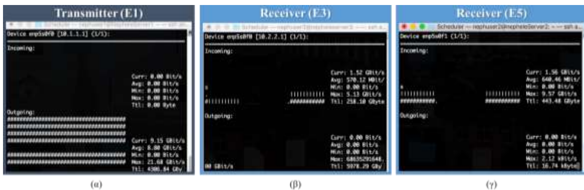
Εικόνα 117: (α) Ο server E1 (10.1.1.1) στέλνει κίνηση δεδομένων (β) στον server E3 (10.2.2.1) και (γ) server E5 (10.2.2.129) επιτυγχάνοντας εύρος ζώνης σχεδόν 1,4 Gb/s σε κάθε server.
