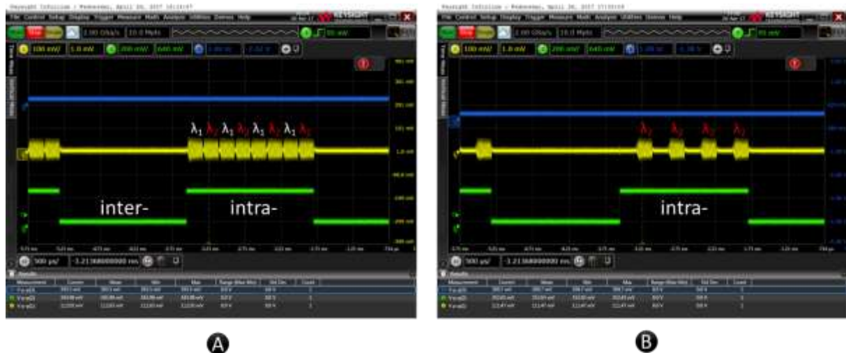
Εικόνα 78: Στιγμιότυπα των πακέτων που είναι εγγεγραμμένα στα \lambda_1 και \lambda_2 και περνούν από τη διαδρομή intra-rod. Τα σημεία A και B υποδεικνύονται στην πειραματική διάταξη του σχήματος 77.
