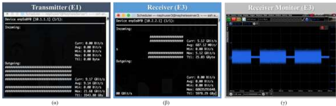
Εικόνα 115: (α) Τα πακέτα που αποστέλλονται από τον server E1 (10.1.1.1) του ToR1 και λαμβάνονται από το server E3 (10.2.2.1) του ToR2. Σε αυτήν την περίπτωση, το 75% της περιόδου προγραμματισμού (60 από τα 80 slots) καταλαμβάνεται για τη διαδρομή επικοινωνίας μεταξύ ToR1 και ToR2 επιτυγχάνοντας εύρος ζώνης 5,12 Gb/s.
