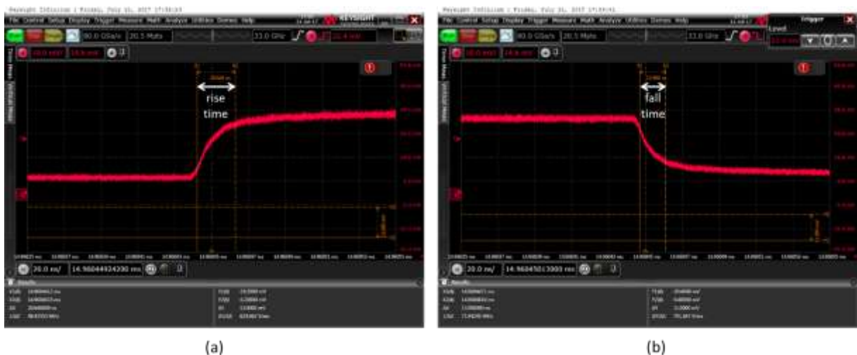
Εικόνα 42: Χρόνος μεταγωγής του 4x4 οπτικού διακόπτη PLZT. (α) Χρόνος ανόδου και (β) Χρόνος πτώσης. Οι χρόνοι ανόδου και πτώσης μετρήθηκαν στο 10% και 90% του ρεύματος εξόδου της φωτοδιόδου (μέτρηση 10-90).
