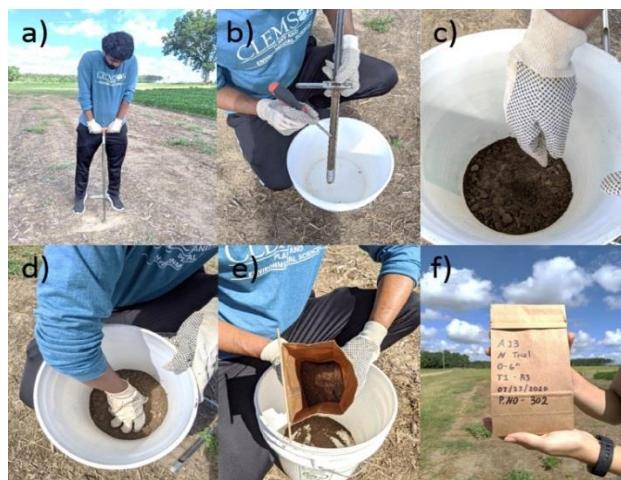
Εικόνα2.8 Οπτική περιγραφή της διαδικασίας δειγματοληψίας με σωλήνα PVC
