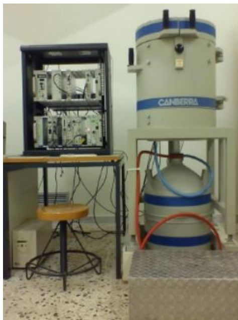
Εικόνα 6.2 Το σύστημα CSS συνδεδεμένο στον ανιχνευτή XtRa
