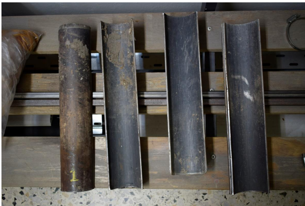
Εικόνα 5.4 Οι σωλήνες DIN που χρησιμοποιήθηκαν για την λήψη καρótων
