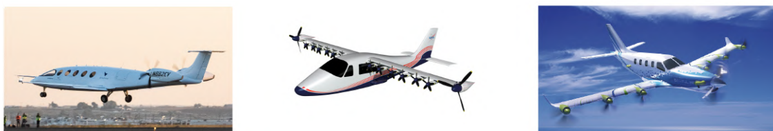
Σχήμα 1.2: Αριστερά: Eviation Alice, Πρώτη πτήση: 27-09-2022 [8]. Κέντρο: NASA X-57 Maxwell, Αμιγώς ηλεκτρικό με εφαρμογή κατανεμημένης ηλεκτρικής ώσης [9]. Δεξιά: Daher EcoPulse, Υβριδικό σύστημα με εφαρμογή κατανεμημένης ηλεκτρικής ώσης [10].
