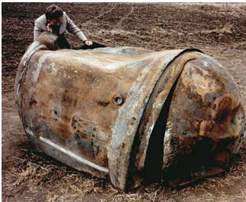
Σχήμα 1-2. Κύρια δεξαμενή προωθητικού αερίου του οχήματος εκτόξευσης Delta 2, που προσγειώθηκε στο Georgetown του Texas.
