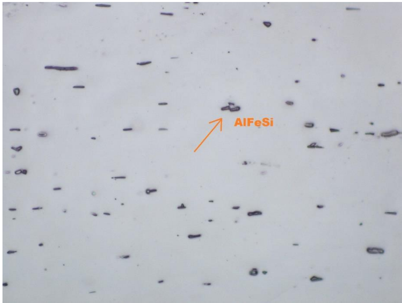
Σχήμα 39 : Μικροδομή δοκιμίου Φ1 (0% παραμόρφωση και φυσική γήρανση) σε μεγέθυνση x100 και με προσβολή διαλύματος υδροφθορίου (HF).
