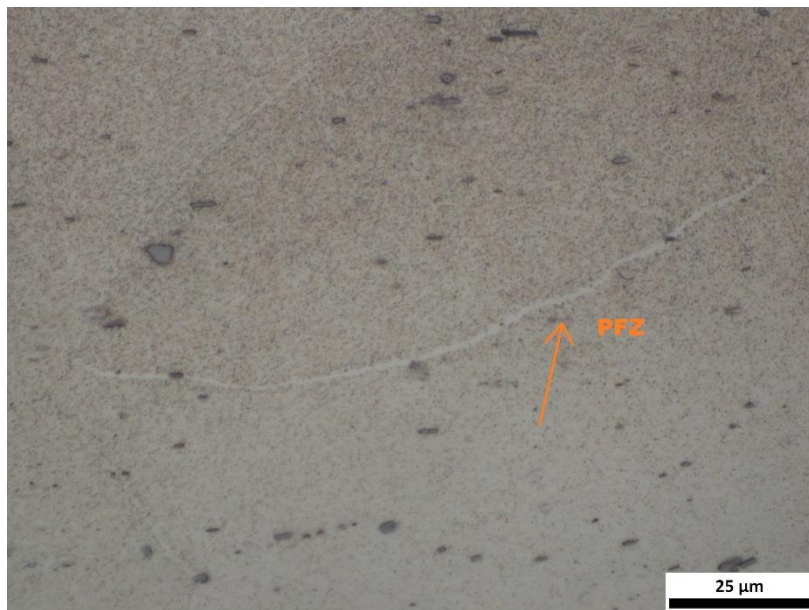
Σχήμα 45 : Μικροδομή δοκιμίου T8-600 (10% παραμόρφωση και τεχνητή γήρανση στους 210°C για 600 λεπτά) σε μεγέθυνση x100 και με προσβολή διαλύματος υδροφθορίου (HF).
