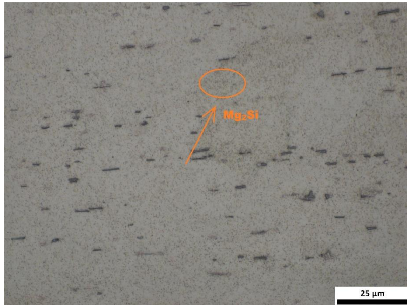
Σχήμα 43 : Μικροδομή δοκιμίου T8-600 (10% παραμόρφωση και τεχνητή γήρανση στους 180°C για 600 λεπτά) σε μεγέθυνση x100 και με προσβολή διαλύματος υδροφθορίου (HF).
