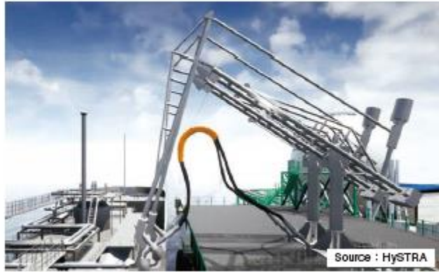
Σχήμα 4.4. Σύστημα περιστρεφόμενου βραχίονα για μεταφορά υδρογόνου (Kawasaki) [33].
