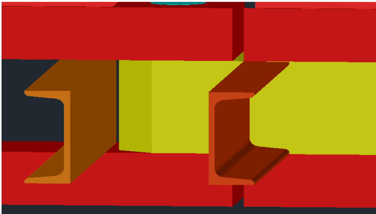
Σχήμα 5-2: Γεωμετρία σύνδεσης ορθοστάτη στον αρσενικό υποδοχέα(κίτρινο χρώμα)
