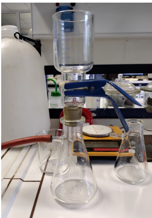
Εικόνα 11. 2 Διάταξη διήθησης υπό κενό με φίλτρο κυταρρίνης πορώδους 0,45 \mu\text{m} .
