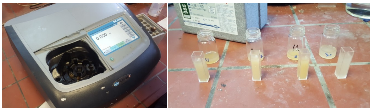
Εικόνα 10. 5 Φασματοφωτόμετρο ορατού-υπεριώδους (αριστερά) και δείγματα προς ανάλυση μέσα σε κυψελίδες (δεξιά).
