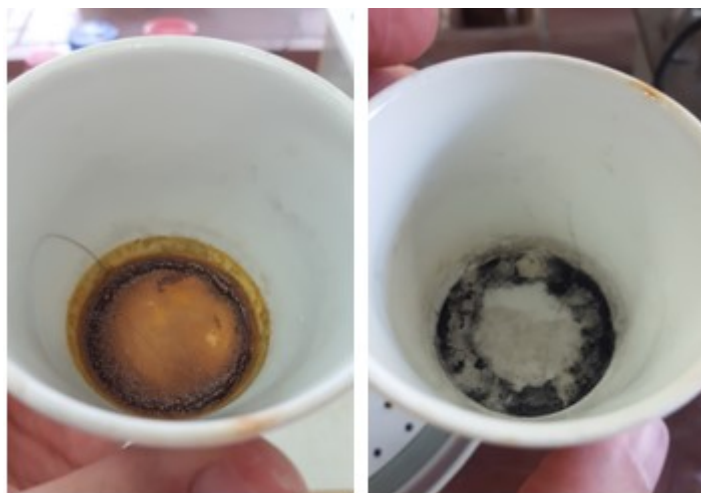
Εικόνα 10. 6 Κάψα μέτρησης βιομάζας μετά την ξήρανση (αριστερά) και μετά την εξαέρωση (δεξιά).
