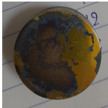
Εικόνα 3.11: Αποκόλληση επικάλυψης από το υπόστρωμα σε λουτρό συγκέντρωσης \text{TiO}_2 30 \text{ g/L} υπό συνθήκες συνεχούς ρεύματος
