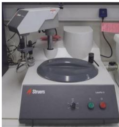
Εικόνα 3-13 Εξοπλισμός λείανσης - στίλβωσης τύπου "Struers, LaboPol-5" του «Εργαστηρίου Ναυπηγικής Τεχνολογίας»
