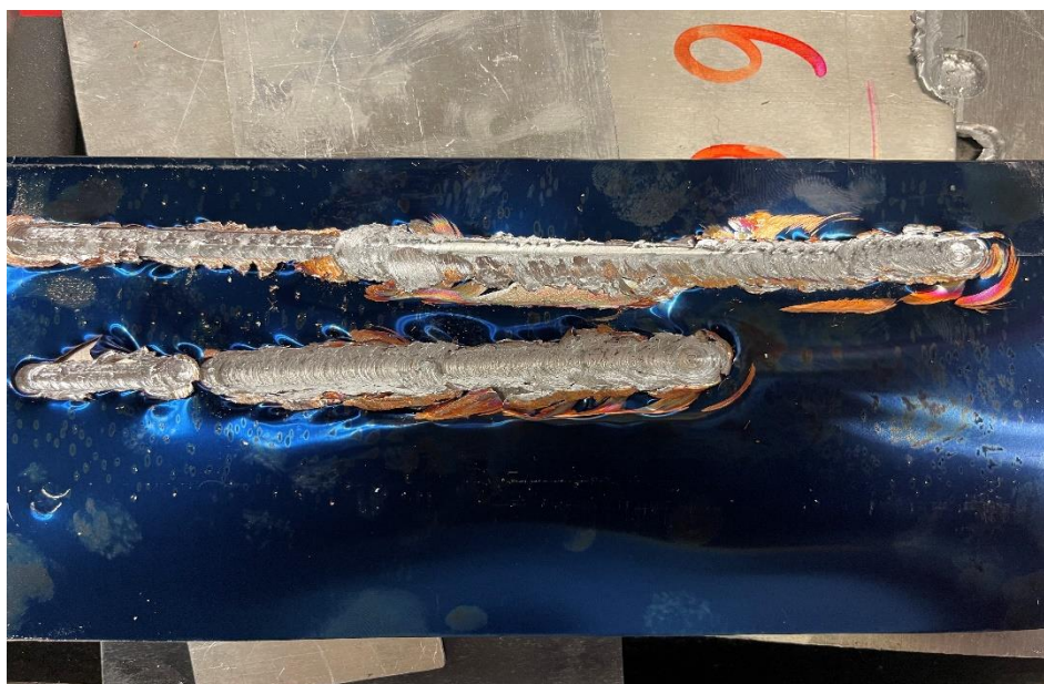
Εικόνα 3-8 Παρουσίαση των ελαττωματικών πάσων με εργαλείο με σπείρωμα
