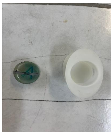
Εικόνα 3-12 Καλούπι Φ30 και δοκίμιο μετά από εγκιβωτισμό
