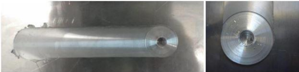
Εικόνα 2-2 Οπή πείρου σε κράμα αλουμινίου AA6082-T6 κατά την απομάκρυνση του εργαλείου [4]
