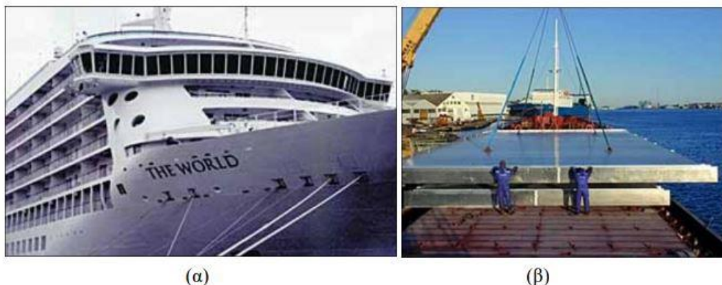
Εικόνα 2-14 (α) Κρουαζιερόπλοιο «The World», της εταιρείας Fosen Mek, (β) ενισχυμένα ελάσματα καταστρώματος προκατασκευασμένα με FSW για το κρουαζιερόπλοιο «The World». [3]
