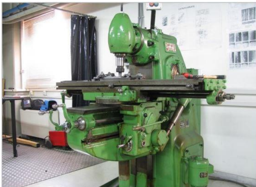
Εικόνα 3-5 Τροποποιημένη φρεζομηχανή για συγκόλληση FSW (EKT-Σχολή ΜΜ)
