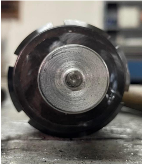
Εικόνα 3-6 Το εργαλείο συγκόλληση που χρησιμοποιήθηκε σε όψη στο επίπεδο xy και yz
