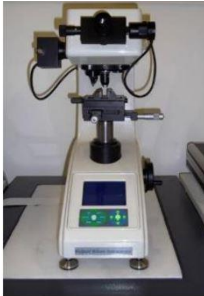
Εικόνα 3-16 Το μικροσκληρόμετρο "Wolpert Wilson 402MVD" του ENT
