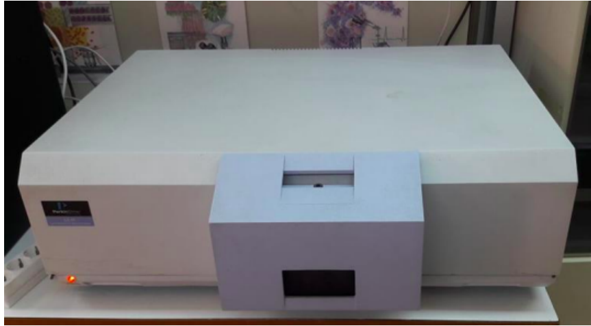
Εικόνα 2.1: Το φασματοφωτόμετρο φθορισμού Perkin-Elmer LS 45 Luminescence Spectrometer
