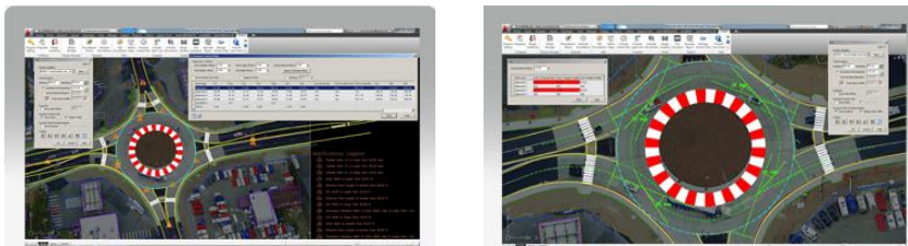
Εικόνα 4-9: Ανάλυση «ταχύτερης διαδρομής» (Αριστερά) και επικάλυψης μονοπατιού για τους κυκλικούς κόμβους πολλαπλών λωρίδων (Δεξιά) στο TORUS [Πηγή: https://www.issd.com.tr/en/44841/TORUS ]
