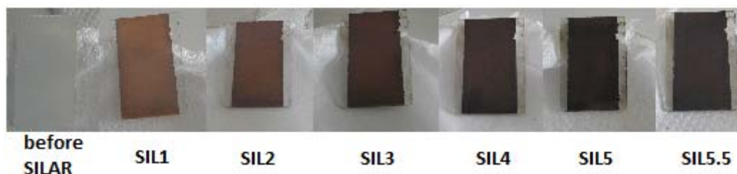
Σχήμα 4.15: Διαδοχική φωτογράφιση ενός υμενίου της μορφής PbS/TiO 2 /γυαλί μικροσκοπίου ύστερα από την ολοκλήρωση κάθε κύκλου ευαισθητοποίησης SILAR.
