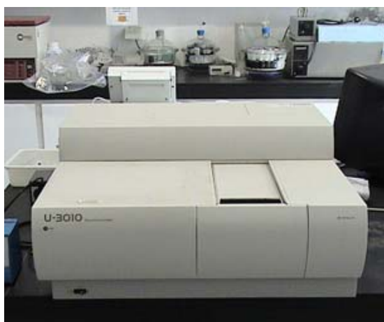
Εικόνα E1: Φασματόμετρο Hitachi U-3010 UV-Visible Diffuse reflectance spectrophotometer του εργαστηρίου Raman του Ινστιτούτου φυσικοχημείας του Ε.Κ.Ε.Φ.Ε. «Δημόκριτος».
