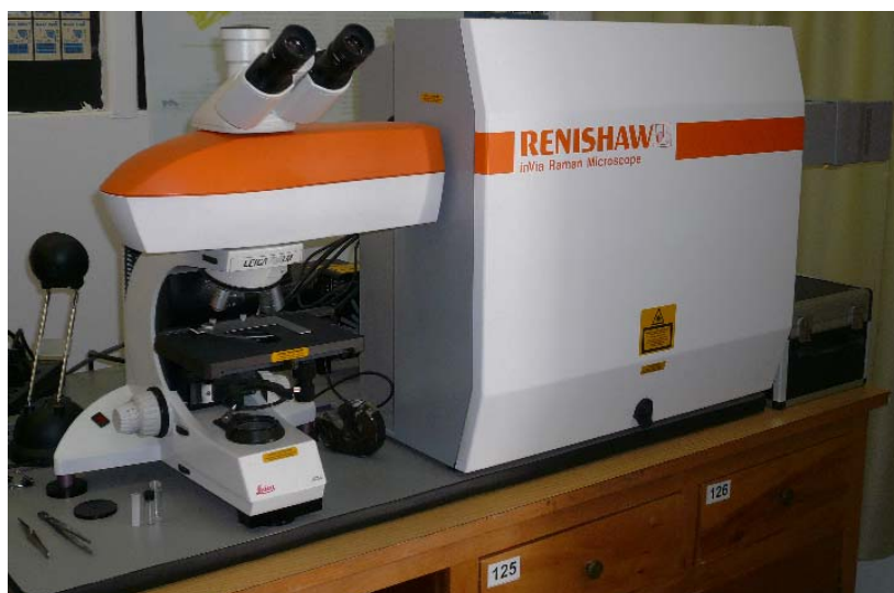
Εικόνα Ε5: Φασματοόμετρο διασποράς Renishaw InVia- Reflex του εργαστηρίου Raman του Ινστιτούτου φυσικοχημείας του Ε.Κ.Ε.Φ.Ε. «Δημόκριτος».
