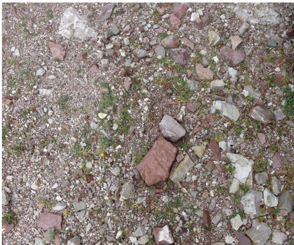
Σχήμα 5-4: Παρουσία πηλικών στο γεωυλικό (φωτογραφία από το έδαφος στη βάση του δρόμου στην περιοχή μελέτης)
