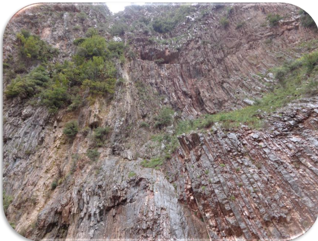
Εικόνα 5-1: ΤΕ 1 : Τύπος ΒC: Αδιατάρακτος λεπτοστρωματώδης ασβεστόλιθος
