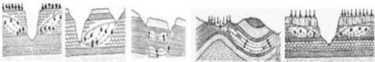
Εικόνα 4-11: Κίνηση νερού σε κεκλιμένα τεκτονισμένα στρώματα (Σημειώσεις Τεχνικής Γεωλογίας II)
