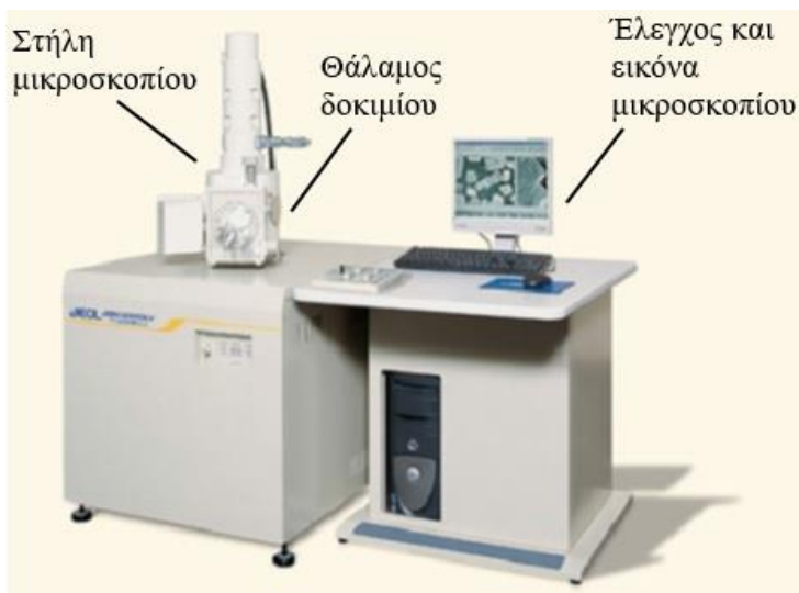
Εικόνα 58. Διάταξη SEM. Οι βασικές διατάξεις που υπάρχουν στη στήλη του μικροσκοπίου είναι: το σύστημα παραγωγής δέσμης ηλεκτρονίων, το σύστημα κατεύθυνσης της δέσμης, το σύστημα πληροφοριών και το σύστημα κενού
