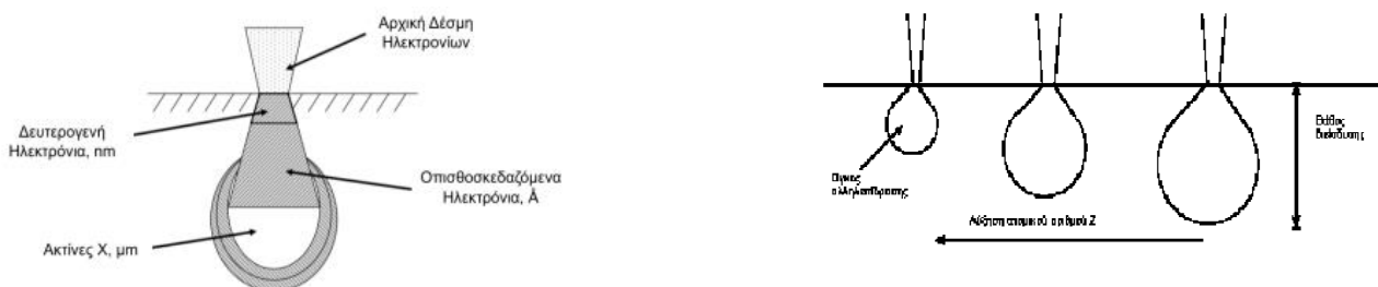
Εικόνα 59. Όγκος αλληλεπίδρασης και περιοχές από τις οποίες ανιχνεύονται δευτερογενή οπισθοσκεδαζόμενα ηλεκτρόνια και ακτίνες X (επίδραση σε αυτόν του ατομικού αριθμού (Z) και του δυναμικού επιτάχυνσης).
