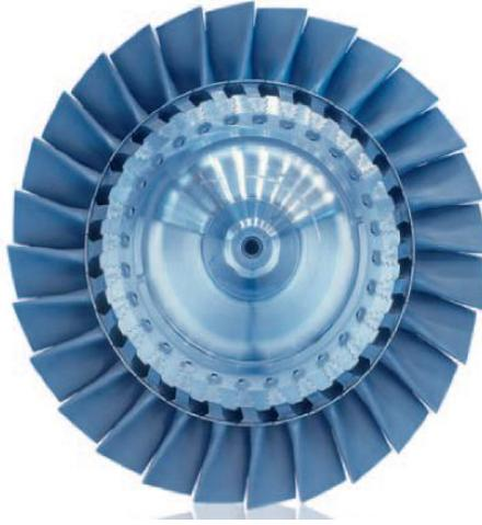
**Σχήμα 3.25: Πτερώγια πτερωτής ακτινικού συμπιεστή.**
