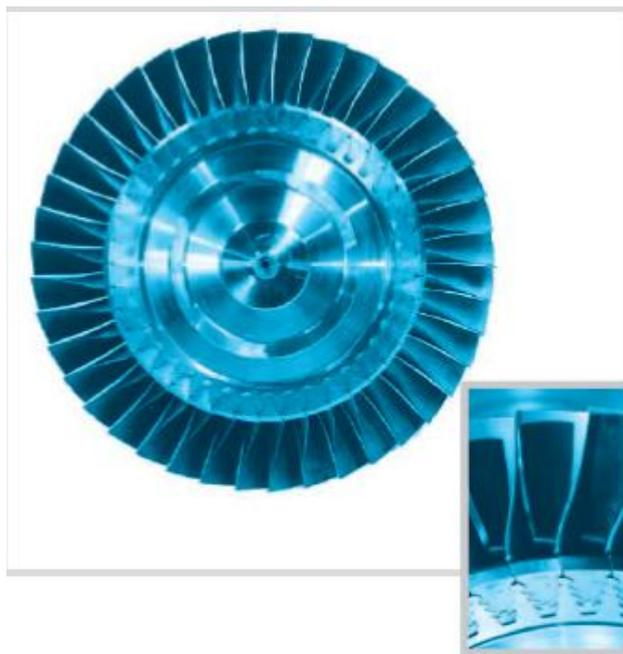
Σχήμα 3.26: Πτερύγια στροβίλου.
