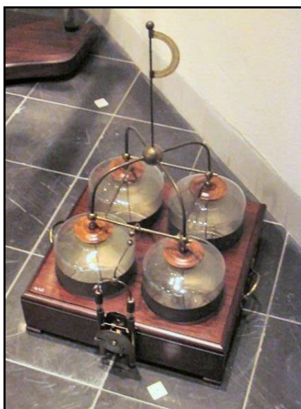
Σχήμα 2: Το βάζο Leyden, συσκευή αποθήκευσης στατικού ηλεκτρισμού [3]
