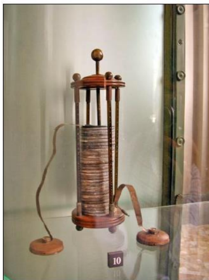
Σχήμα 4: Η βολταϊκή στήλη, η πρώτη χημική μπαταρία [6]
