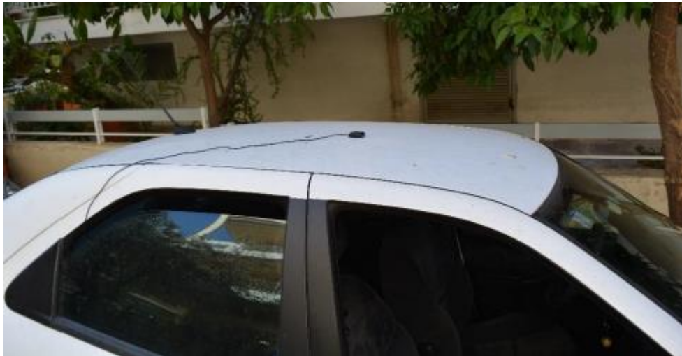
Εικόνα 4.2: Τοποθέτηση δέκτη GNSS στο κέντρο της οροφής οχήματος του πειράματος [18].
