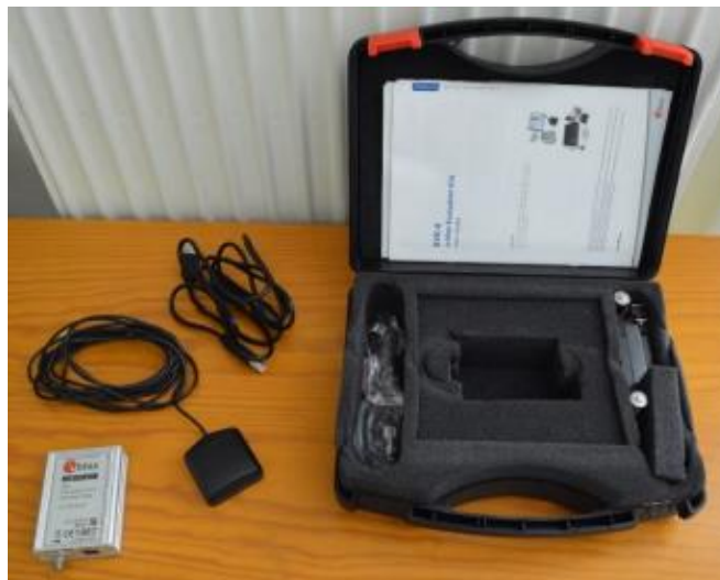
Εικόνα 4.1: Συσσκευή GNSS τύπου u-blox EVK-6T-0 που χρησιμοποιήθηκε στο πείραμα [18].
