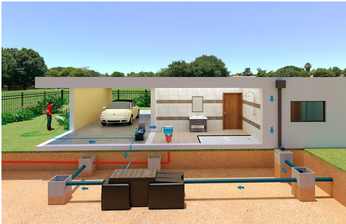
Εικόνα 19 Σύστημα συλλογής και επαναχρησιμοποίησης βρόχινου νερού σε επίπεδο οικίας (Enflow)
