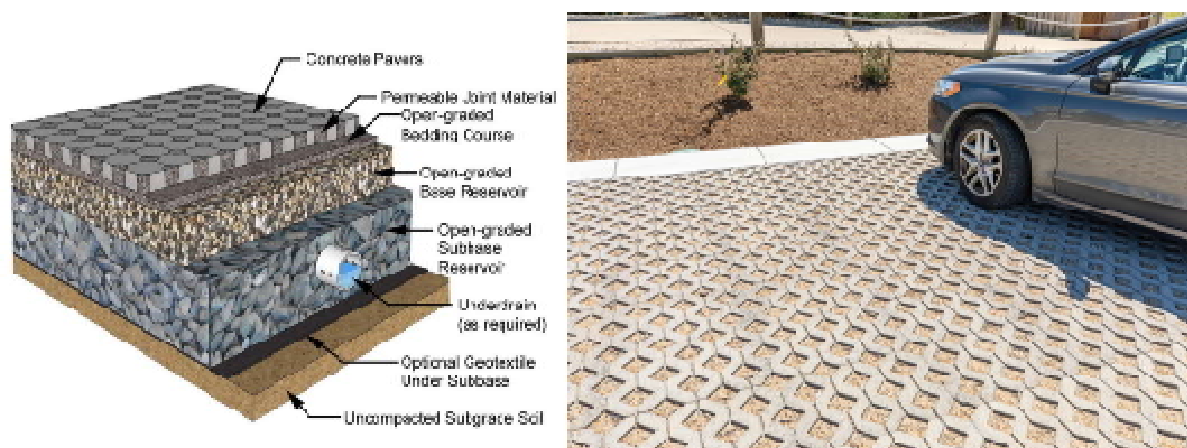
Εικόνα 11 Υδατοπερατά πεζοδρόμια σε αναπαράσταση (αριστερά, Smith D., 2006) και σε πραγματικό έργο (δεξιά, Ephenry ecocenter)
