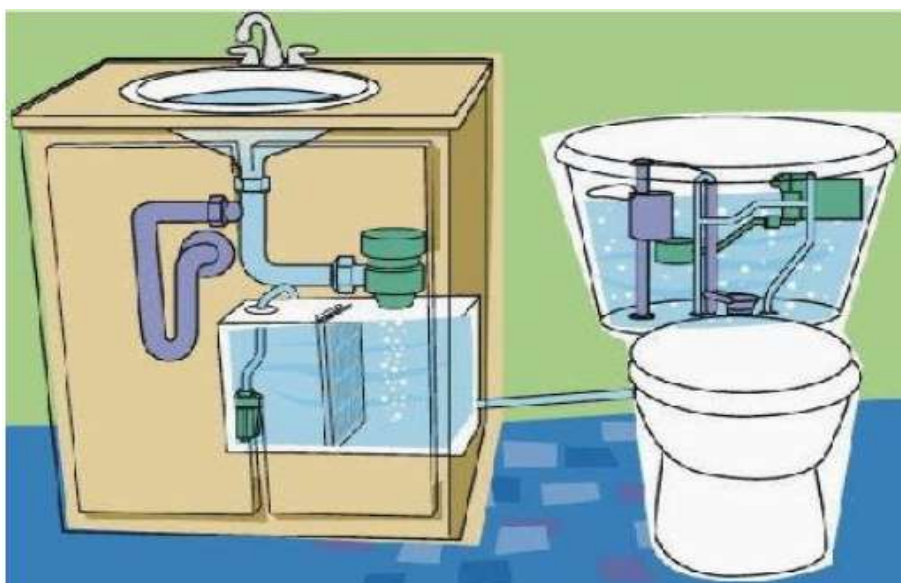
Εικόνα 23 Παράδειγμα συστήματος επαναχρησιμοποίησης γκρι νερού σε οικιακό μπάνιο (Moraitis et al., 2021)
