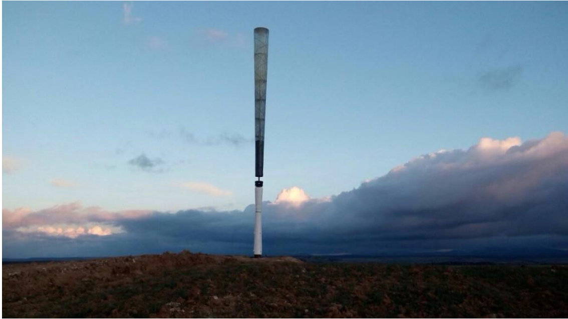
Σχήμα 2.1: Α/Γ Vortex Bladeless (Williams M., 2015)
